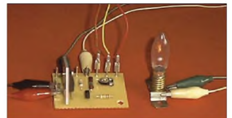
Bild 7: Für den ersten Funktionstest reicht statt des Lüfters auch eine vorübergehend angeklebte Glühlampe. Fotos: DO2AV
