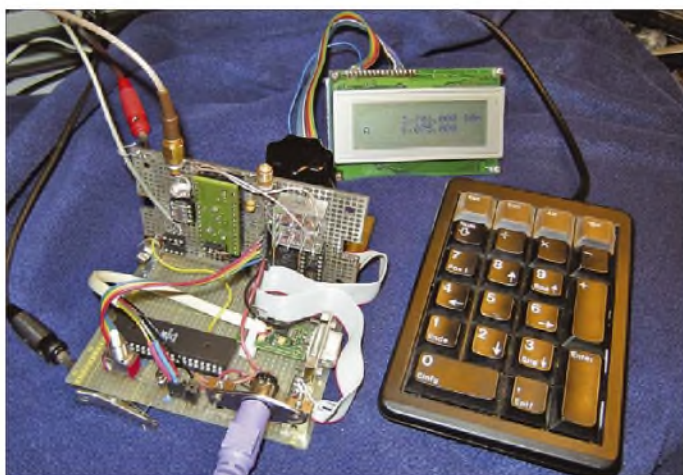
Bild 1: Versuchsaufbau DDS-VFO von DL7IY mit Drehgeber, PS/2- Nummerntastensfeld von Cherry, Display und dem Controller ATmega 32
