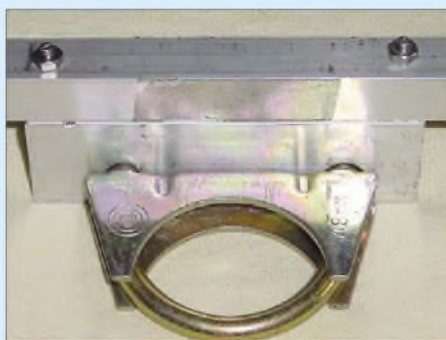
Bild 7: Die Masthalterung nach DK7ZB [9] besteht aus einem kräftigen Aluminiumwinkel und einer Kfz-Auspuffschelle
