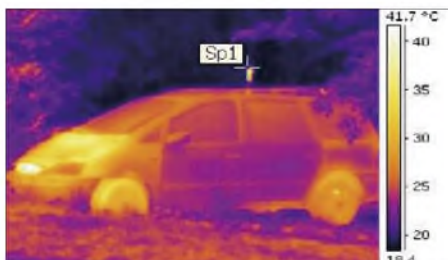
Bild 2: Erwärmung bei intensiven SendebetrieB im Stand, Infrarotaufnahme Temperatur Spot 1: 41,7 °C. Das Fahrzeug strahlt noch Restwärme aus dem FahrbetrieB ab.
