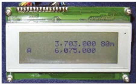
Bild 6: Als Anzeige lassen sich auch vierzeilige Displays mit je 20 Zeichen verwenden.
