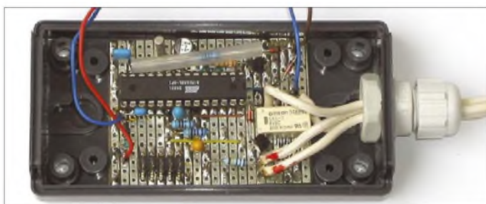
Bild 4: Schutzschaltung für 6-V-Akkumulatoren mit einem 2-A-Relais und dem Mikrocontroller ATmega8
