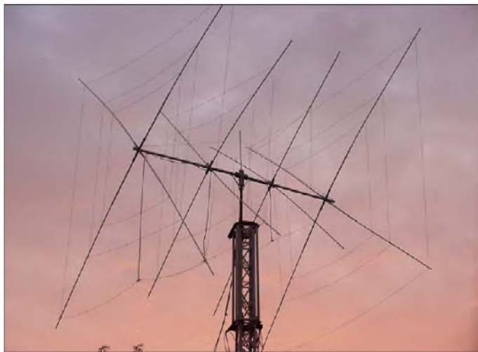
Bild 1: Fertige Antenne nach dem Umbau im Garten des Autors Fotos und Screenshots: DD7DX
