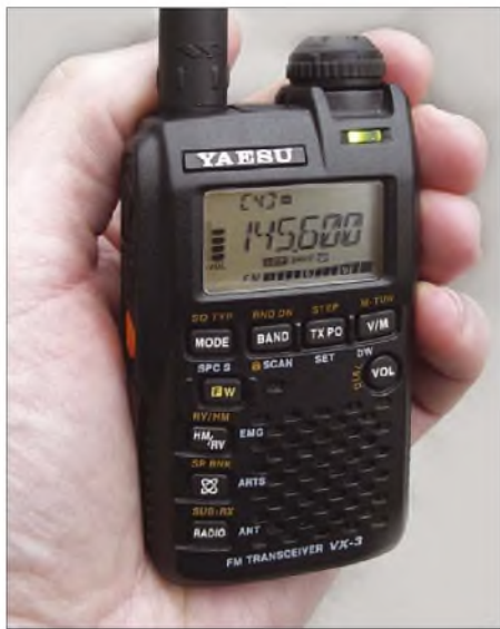
Bild 1: Das VX-3E ist mehr als nur ein Handschmeichler. Zum Funkgerät gesellt sich nun noch ein vollwertiger Rundfunkempfänger.
