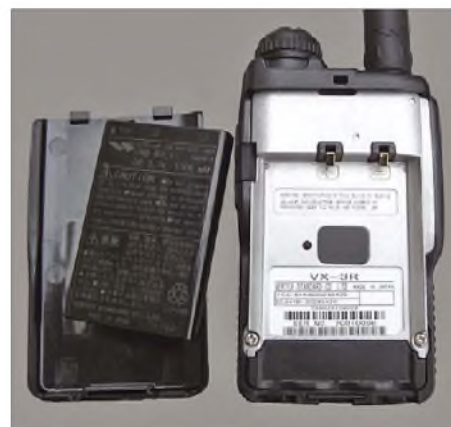
Bild 4: Der Li-Ion-Akkumulator passt in das rückseitige Fach im Druckguss-Kühlkörper. Hinter einem Aufkleber befindet sich eine Öffnung für Modifikationen.
