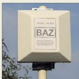
Diese WLAN-Richtantenne ist für Montage in horizontaler wie auch vertikaler Polarisation geeignet.
