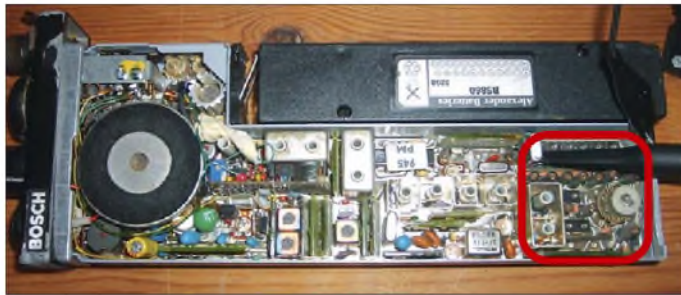
Bild 1: Das FuG 10 eignet sich durch den Aufbau mit bedrahteten Bauelementen gut für die Umrüstung zum 2-m-FM-Handfunkgerät. Im markierten Hauptoszillator sind lediglich die Quarze zu ändern.
