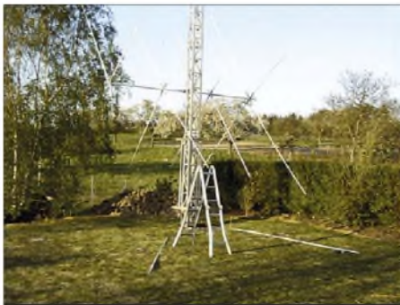
Bild 10: Der Umrechnungsfaktor 0,95 für isolierte Litze erwies sich als zu stark verkürzend, hier musste neu gebohrt und verlängert werden.
