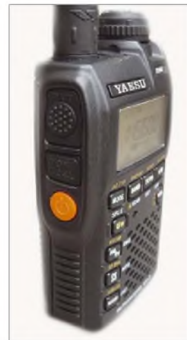
Bild 2: Griffig ist die Sendetaste gestaltet. In ihrer unmittelbaren Nähe sitzt die Sendestufe.
