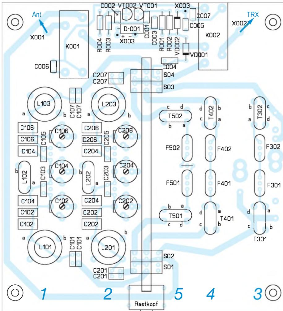
**Bild 27:** Bestückungsplan für die Vorfilterplatine *PLB-018* in der Grundvariante, M1:1; der Filtertrakt 5 ist zurzeit nur als Reserve zu betrachten, da es noch kein drittes monolithisches Quarzfilter wie 7007M15A oder 7022M15A gibt.
