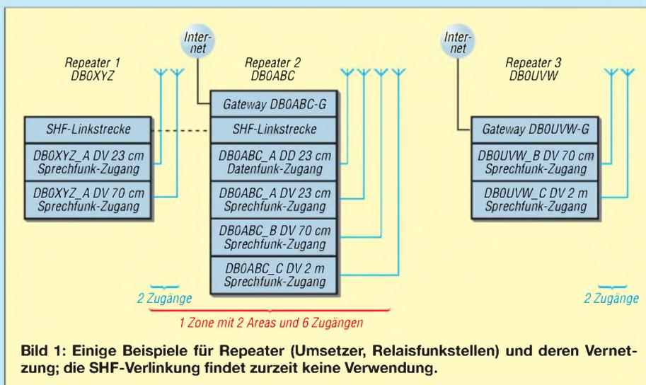
**Bild 1: Einige Beispiele für Repeater (Umsetzer, Relaisfunkstellen) und deren Vernetzung; die SHF-Verlinkung findet zurzeit keine Verwendung.**
