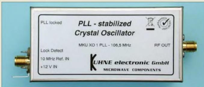
Diese frequenzstabile Signalquelle für Transvertermodule ist als Ersatz für einen OCXO einsetzbar.
