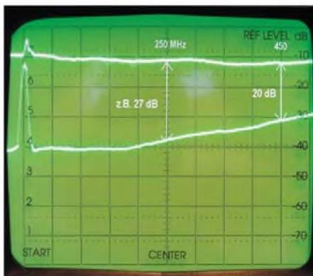
**Bild 18: Richtschärfe der mit dem Hybridkopppler aufgebauten Richtkoppplerbrücke; die Richtschärfe ist als Abstand zwischen beiden Kurvenzügen abzulesen, vertikal 10 dB/Div., horizontal 50 MHz/Div.**
