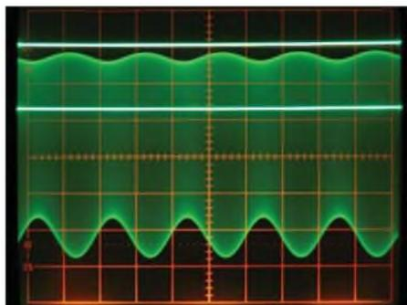
**Bild 3:** Spannungsverlauf am Gitter bei einem Hochfrequenzsignal von 600 kHz, das mit 1 kHz zu ungefähr 30% moduliert ist. Der obere Strich markiert die Nulllinie, der untere Strich gibt den Spannungswert wieder, der vom Gitteranlaufstrom am Widerstand der Audionkombination ohne Signal gebildet wird. Das grüne Band stellt das zeitlich nicht aufgelöste Hochfrequenzsignal dar.  $x = 0,5 \text{ ms/Skt}$ ,  $y = 200 \text{ mV/Skt}$
