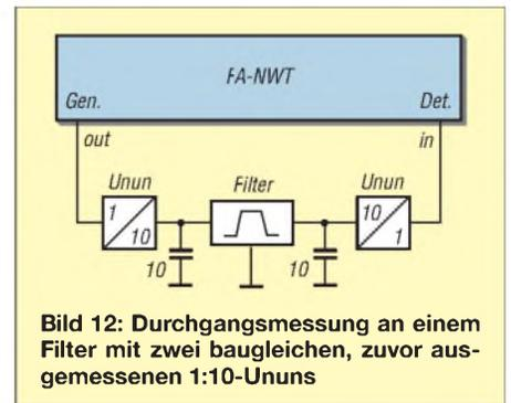
**Bild 12:** Durchgangsmessung an einem Filter mit zwei baugleichen, zuvor ausgemessenen 1:10-Ununs
