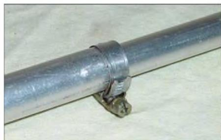
**Bild 7: Verbindung zwischen 16-mm- und 12-mm-Rohren mit Schlauchschelle**
