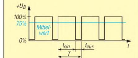
Bild 4: PWM-Signal mit einer Ausgangsspannung von 75% des Maximalwerts
