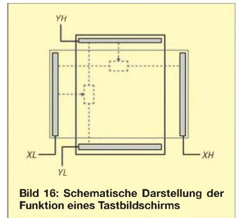
**Bild 16:** Schematische Darstellung der Funktion eines Tastbildschirms
