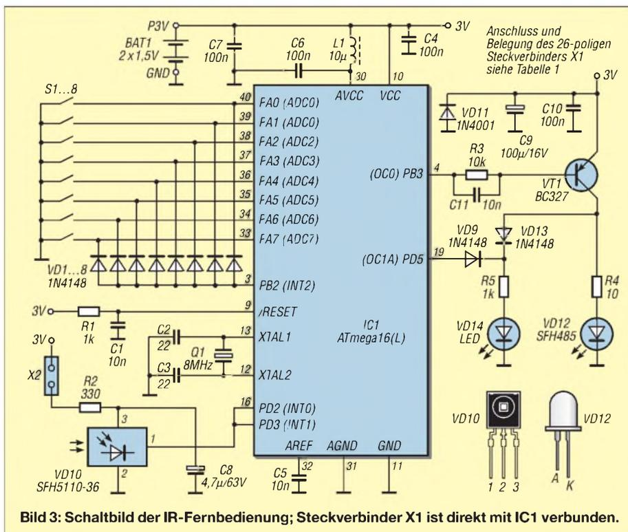
Bild 3: Schaltbild der IR-Fernbedienung; Steckverbinder X1 ist direkt mit IC1 verbunden.
