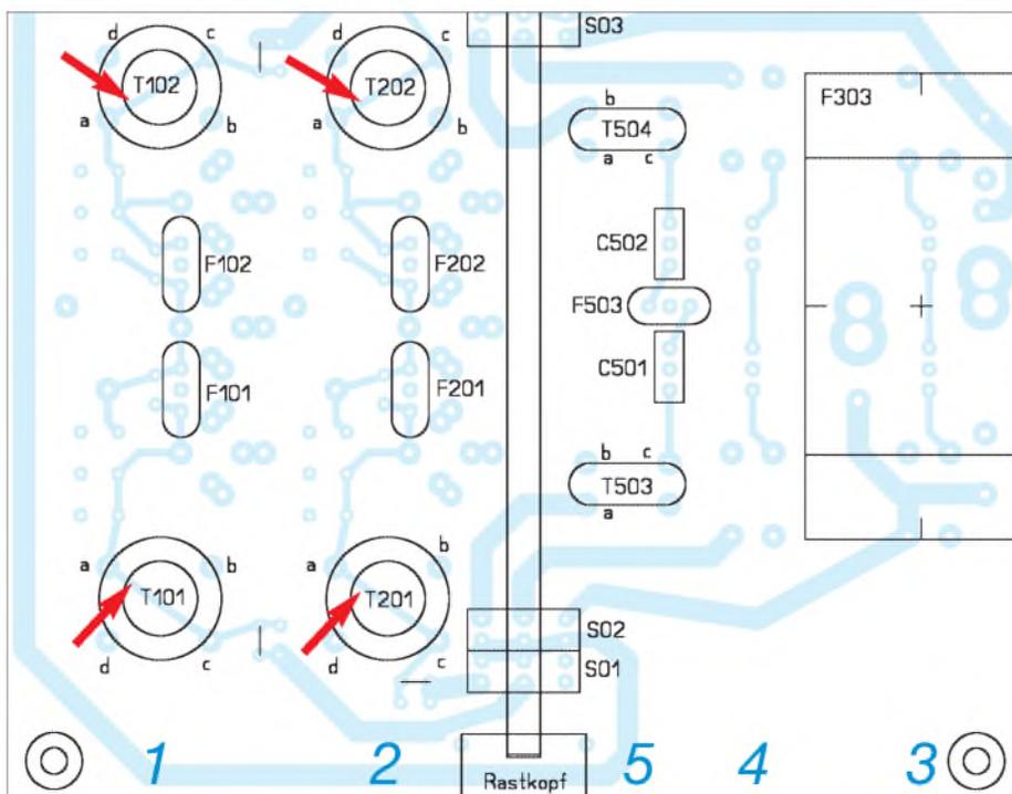
**Bild 28:** Bestückungsalternativen: Die Filtertrakte 1 und 2 nehmen evtl. weitere monolithische Quarzfilter ähnlich 70xxM15A auf, die Leiterzüge a-c unter den Übertragern T101/2 bzw. T201/2 sind dann aufzutrennen. Trakt 5: Murata-Filter; Trakt 3: Quarzfilter XF70-S1x oder Inrad
