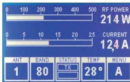
**Bild 15:** MENÜ-A der Endstufensteuerung
