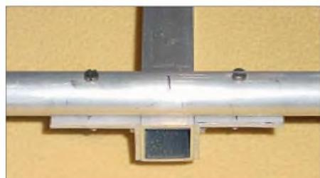
**Bild 6: Elementbefestigung auf Vierkant-Boom**
