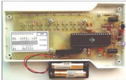
**Bild 2:** Geöffnete Fernbedienung; die Taster werden von der anderen Platineseite aus eingebaut. Fotos: Bauer
