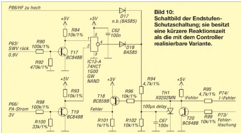
**Bild 10: Schaltbild der Endstufen-Schutzschaltung; sie besitzt eine kürzere Reaktionszeit als die mit dem Controller realisierbare Variante.**
