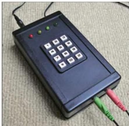
Bild 7: Handliche Aufbauvariante des Sprachverschlüsselers Hektor Foto: Thomas
