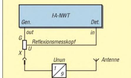
**Bild 6:** Anpassungsmessung an einer Langdrahtantenne mittels 1:9-Ununs
