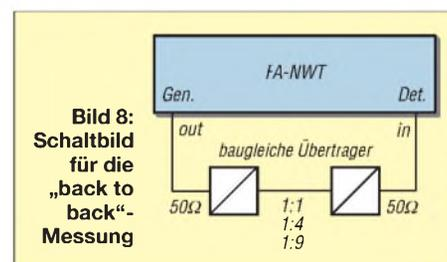
**Bild 8:** Schaltbild für die „back to back“-Messung
