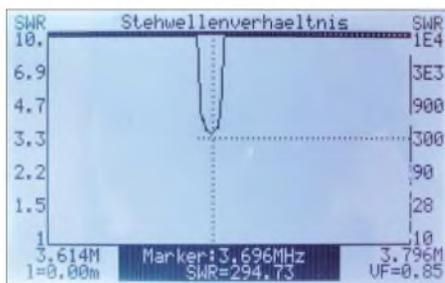
**Bild 11:** Verwendung der höheren SWV-Bereiche als Dipmeter-Anzeige
