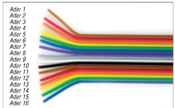
Bild 4: 16-poliges Flachbandkabel
