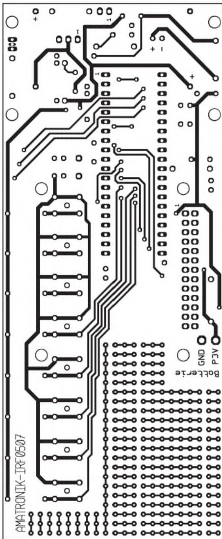
**Bild 5:** Layoutvorschlagnur für die Platinenunterseite der IR-Fernbedienung; Abmessungen (B x H): 60,2 mm x 145,3 mm
