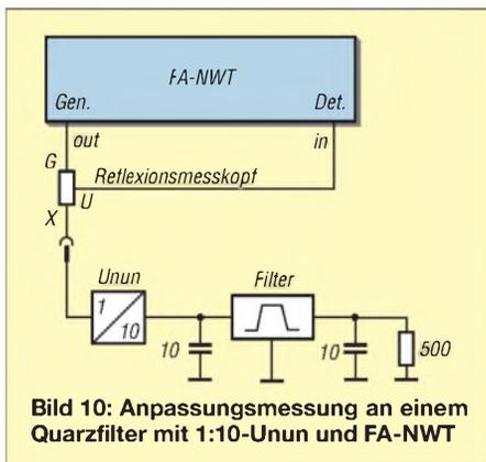
**Bild 10:** Anpassungsmessung an einem Quarzfilter mit 1:10-Unun und FA-NWT
