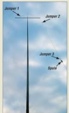
Die bereits im FA 11/07, S. 1204 f., vorgestellte **SQ Vertikal** lässt sich durch Jumper und einen Teleskopstab von 10 bis 80 m ohne Antennenkoppler in Resonanz bringen.
