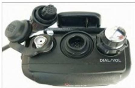
**Bild 4:** Eine ganz ungewöhnliche Buchse dient zum Anschluss von Mikrofon und Datenkabel.
