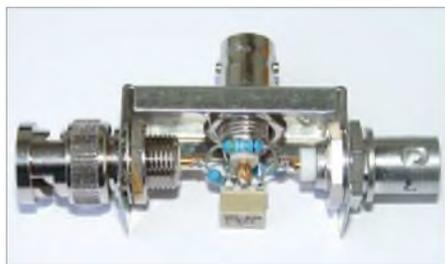
**Bild 15: Fertig aufgebauter Hybridkopppler**
