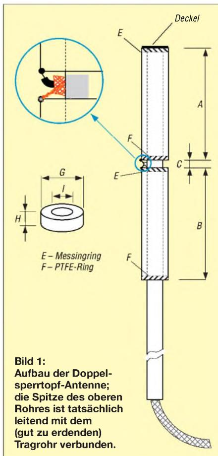
**Bild 1:** Aufbau der Doppelsperrtopf-Antenne; die Spitze des oberen Rohres ist tatsächlich leitend mit dem (gut zu erdenden) Tragrohr verbunden.
