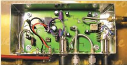
Mit zwei Analogmischern AD831 lässt sich mit wenig Aufwand eine transceiver-fähige Mischerbaugruppe aufbauen, die zur Verarbeitung von IQ-Signalen geeignet ist. Die Baugruppe arbeitet auch noch im 2-m-Band und ist demnächst als Bausatz erhältlich.
