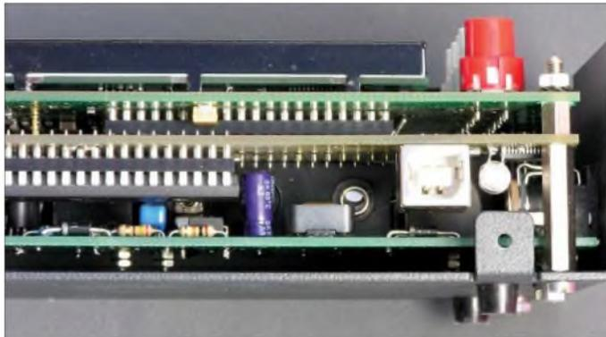
**Bild 1:** Einbausituation: Oben die Hauptplatine mit Tastern, Display und IC-Fassung, unten die unveränderte Ladeplatine und dazwischen die neu hinzu gekommene Adapterplatine mit USB-Buchse und LED. Der Mikrocontroller sitzt wieder in einer Fassung.
