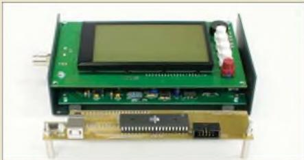
Mit dieser kleinen Zusatzplatine wird der vektoruell arbeitende Antennenanalysator um eine USB-Schnittstelle erweitert, wodurch die Ausgabe und Speicherung der Messdaten auf einem PC möglich ist. Gleichzeitig erhielt die Firmware des Analysators einige zusätzliche Features.
