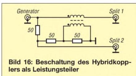
**Bild 16: Beschaltung des Hybridkoppplers als Leistungsteiler**
