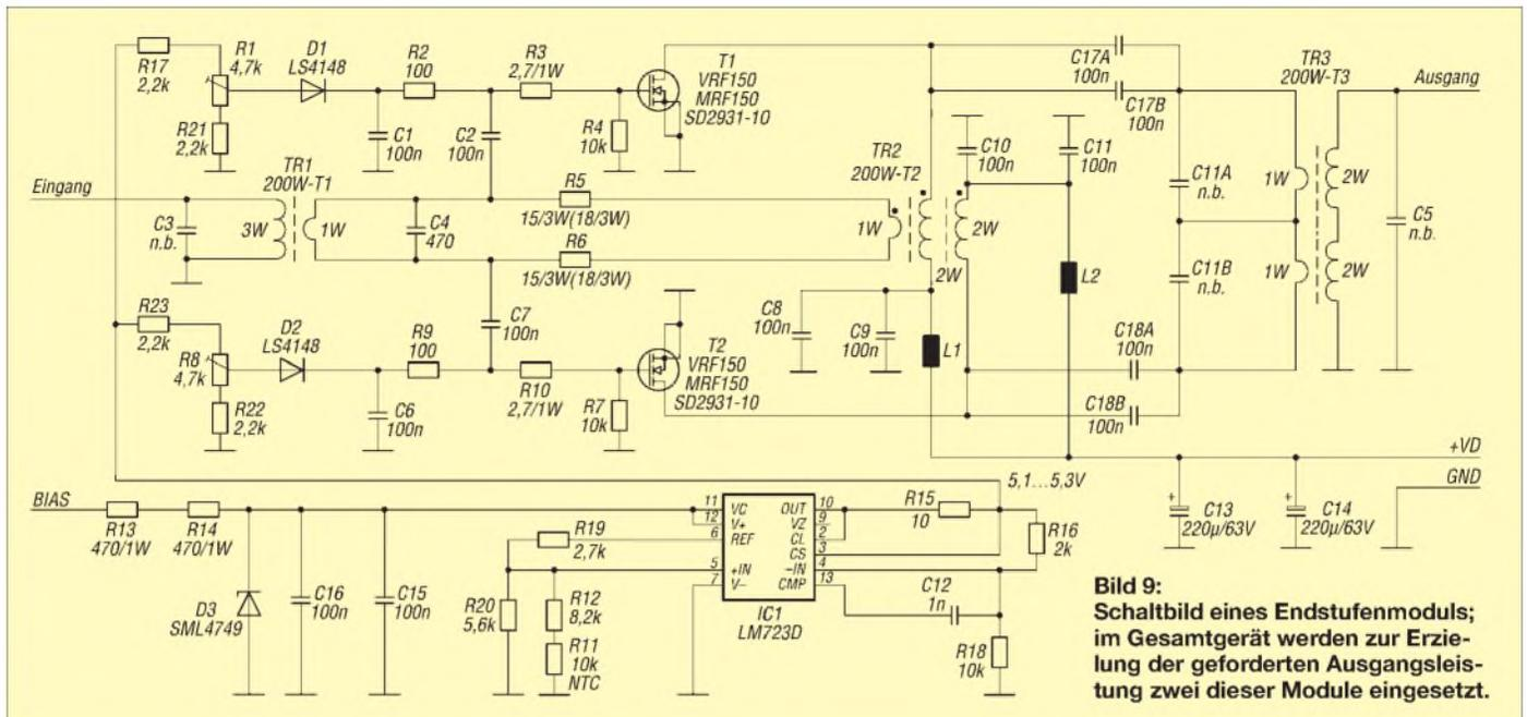
**Bild 9:** Schaltbild eines Endstufenmoduls; im Gesamtgerät werden zur Erzielung der geforderten Ausgangsleistung zwei dieser Module eingesetzt.
