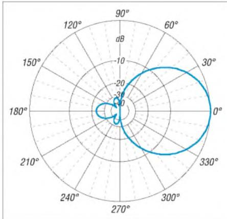
**Bild 11:** Azimutdiagramm bei 28,5 MHz für den Freiraum, 0 dB ± 6,31 dBd
