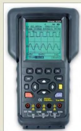
Handliches Digitaloszilloskop mit Frequenzzähler
