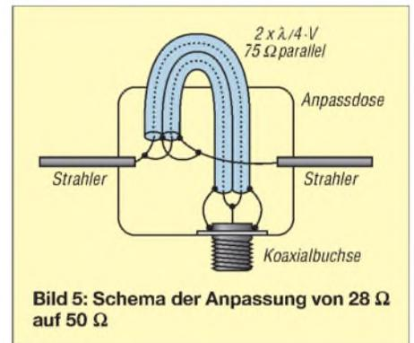
Bild 5: Schema der Anpassung von 28 Ω auf 50 Ω
