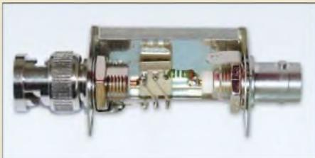
Spulen wickeln, besonders für Breitbandübertrager, ist nicht jedermanns Sache. Daher zeigen wir hier, wie sich auf der Basis eines fertig bewickelt erhältlichen Übertragers mit drei Wicklungen nützliche Messhilfsmittel anfertigen lassen.
