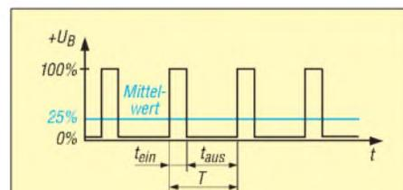
Bild 3: PWM-Signal mit einer Ausgangsspannung von 25% des Maximalwerts
