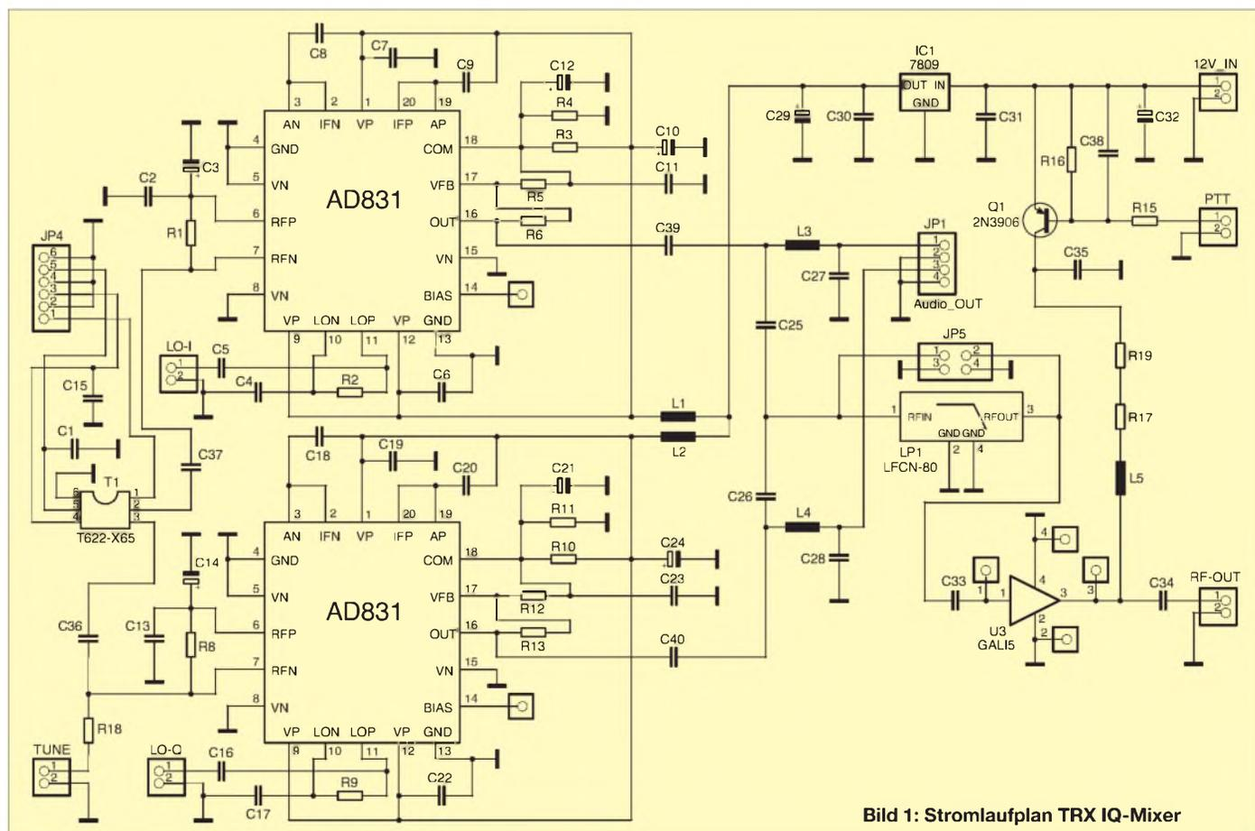
Bild 1: Stromlaufplan TRX IQ-Mixer
