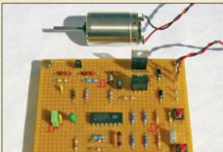
Soll die Leistung von Gleichstromverbrauchern gesteuert werden, sind Gleichspannungssteller einsetzbar. Greift man jedoch auf die Pulsweitenmodulation zurück, ist die Steuerung fast verlustlos möglich und die erforderliche Baugruppe wird kleiner.
