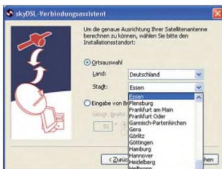
**Bild 14:** Zur Berechnung der genauen Ausrichtung muss der nächstgelegene Ort ausgewählt werden.
