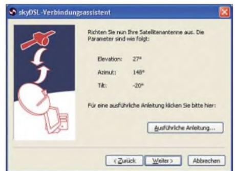
**Bild 17:** Die errechneten Daten für die Ausrichtung am lokalen Ort werden angezeigt.
