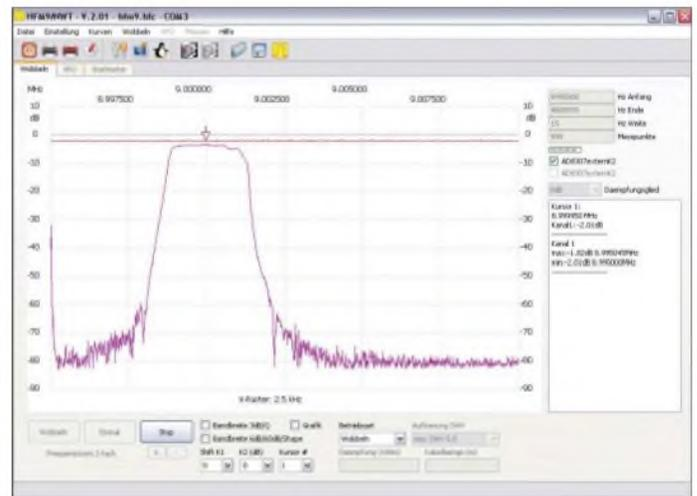
dann kann man die Dämpfung im Durchlassbereich exakt messen. Die Einfügungsdämpfung der beiden Übertrager ist aus einer vorherigen Messung bekannt, man subtrahiert diese Dämpfung von der Ge-
