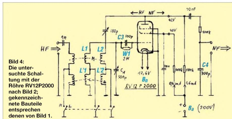
**Bild 4:** Die untersuchte Schaltung mit der Röhre RV12P2000 nach Bild 2; gekennzeichnete Bauteile entsprechen denen von Bild 1.
