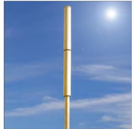
**Bild 2:** Fertig aufgebauter Doppelsperrtopf mit Tragrohr
