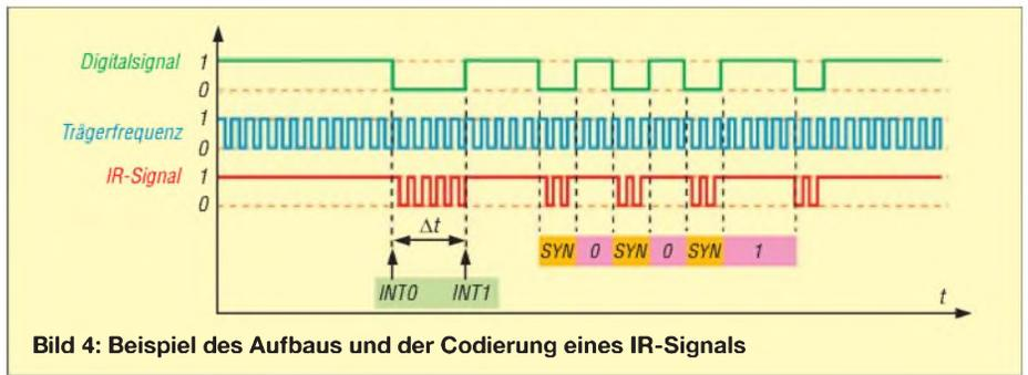
Bild 4: Beispiel des Aufbaus und der Codierung eines IR-Signals
