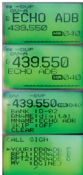
Und schließlich übernehmen sogar die Speicherplätze die Adressierungsdaten (Bild 7). Das ist die Gelegenheit, um für jede häufiger benutzte Verbindung einen eigenen Speicher zu belegen und mit einem entsprechenden Namen zu versehen. Dabei wird die Bedienung schon aufgrund der Fülle der einzugebenden Informatio-
