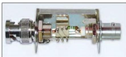
**Bild 3:** Aufgebauter 10:1-Mess-Unun in einem Filtergehäuse FG1B-3
