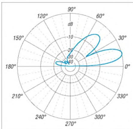
**Bild 12:** Elevationsdiagramm bei 28,5 MHz für eine Höhe von 10 m über realem, durchschnittlich leitfähigem Grund mit  $\sigma = 0,005$  S/m und  $\epsilon_r = 13$ ; 0 dB ± 11,4 dBd, Hauptkeule bei 14°
