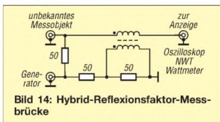
**Bild 14: Hybrid-Reflexionsfaktor-Messbrücke**
