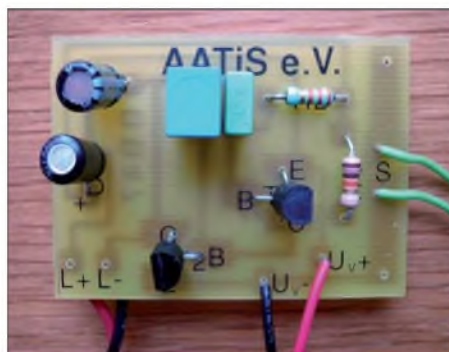
Die Platine BB47 (34 mm × 48 mm) lässt sich sehr einfach bestücken. Die Ergänzung von zwei Fotowiderständen führt zu weiteren Tonvariationen, sodass die Bezeichnung „Nervensäge“ dafür treffend ist. Foto: AATiS
