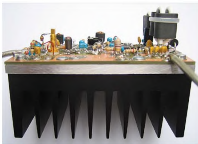
Bild 1: Versuchsaufbau; Verstärker mit Kühlsystem (5-mm-Aluminiumplatte und Kühlkörper)
