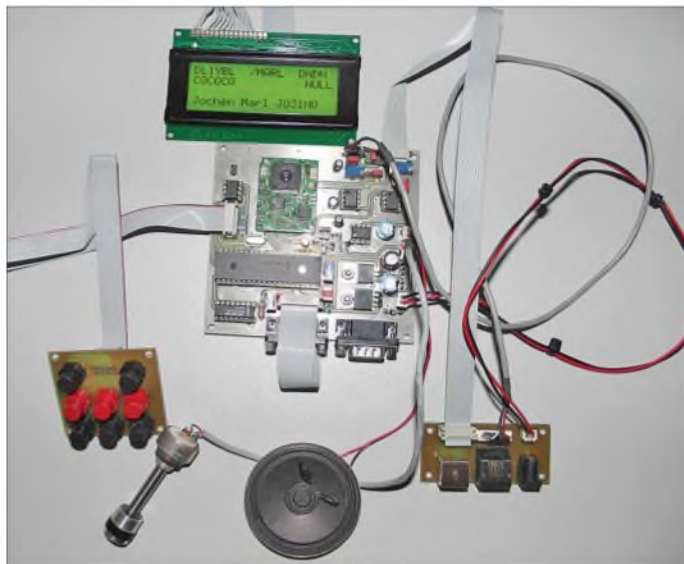
Bild 1: Der betriebsbereite DV-Adapter bietet den gleichen Komfort wie kommerzielle D-STAR-fähige Funkgeräte. Die Aufteilung auf mehrere Einzelplatinen lässt dem Nachbauenden freie Hand bei der Gehäusegestaltung.
