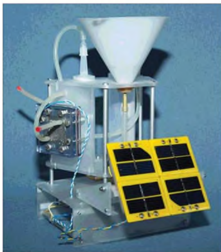
Bild 1: Durch die von der Solarzelle erzeugte Spannung werden in der Brennstoffzelle Wasserstoff und Sauerstoff aus Wasser hergestellt.
