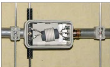
Bild 8: Mittelstück der Fünfelement-Yagi mit der Strahlerdose und der Speisedrossel, die hier nur zur Symmetrierung dient
