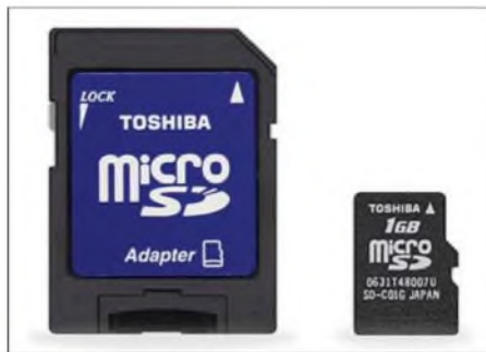
Bild 1: Alternative zur inzwischen obsoleten SmartMedia-Karte: MicroSD-Karte nebst Adapter für SD-Kartenschacht Werkfoto
