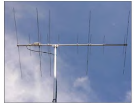
Bild 6: Die neue 1,50 m lange Duoband-Yagi
