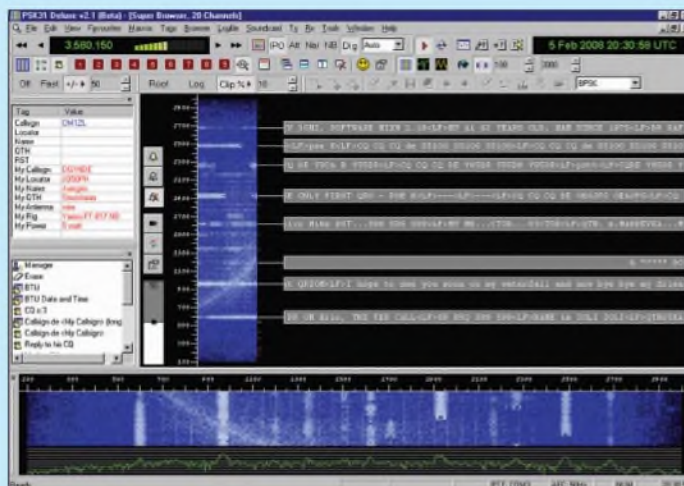
Bild 5: Digipan kann mehrere Signale gleichzeitig decodieren, erfordert jedoch einen etwas leistungsfähigeren Rechner.
