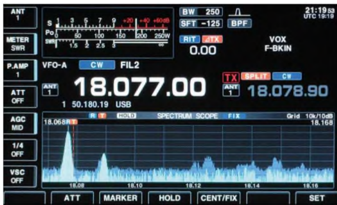
Bild 5: Eine der Display-Erscheinungsformen; das völlig ohne Beeinflussung des Empfangs arbeitende Spektroskop hat mit seinem gesonderten DSP eine bemerkenswerte Qualität erreicht. Neu ist die fixe Darstellungsmöglichkeit für bandweise festlegbare Frequenzbereiche, die klar abzulesen sind.
