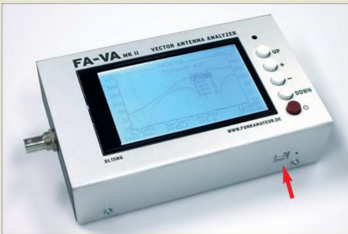
Der vektorielle Antennenanalysator FA-VA MKII wartet dank Zusatzplatine mit einer USB-Schnittstelle auf.
