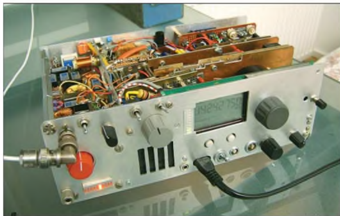
Bild 1: Der kompakte Aufbau des kompletten Gerätes (250 x 80 x 160 mm 3 ) auf überwiegend HF-Lochrasterplatten. Links neben der Frequenzanzeige das S-Meter in 10-dB-Schritten.
