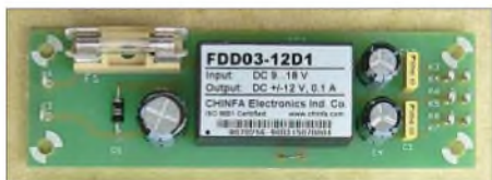
Bild 1: UAP DCW bestückt mit Chinfa-Gleichspannungswandler \pm 12 V
