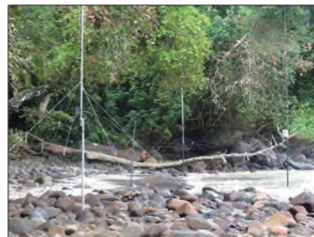
Die Vertikalantennen im Küstenbereich, aufgebaut bei Ebbe; die Wellen spritzten oft bis zu den Radials hoch und veränderten die Stehwellenverhältnisse spürbar.
