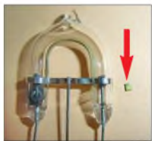
Bild 1: Die kleine Blitz-LED LXCL-PWF3 gibt die gleiche Helligkeit ab wie eine Xenon-Blitzröhre.
