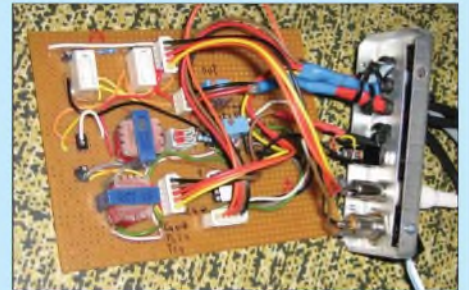
Bild 14: Ansicht des Interfaces zur galvanischen Trennung von PC und Transceiver
