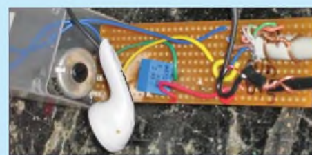
Bild 16: Aufbau der Pegelanpassung auf einer Universalleiterplatte
