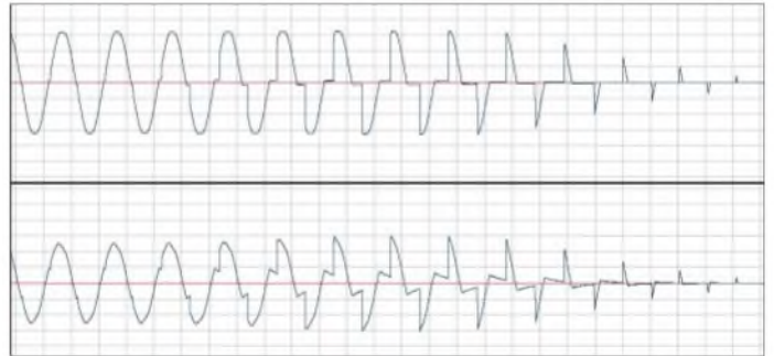
Bild 10: Der Zangenadapter aus Bild 14 (unten) ist nicht in der Lage, die angeschnittenen Stromzeitflächen korrekt wiederzugeben, der Stromwandler 100 A/0,1 A (oben) kann es jedoch.
