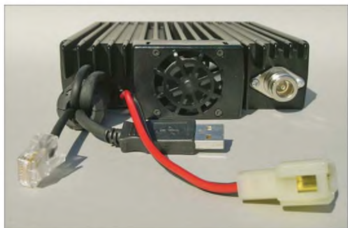
Bild 4: Bis auf Lautsprecher- und Antennenbuchse sind alle Anschlüsse auf der Rückseite über kurze Kabelstücke herausgeführt.
