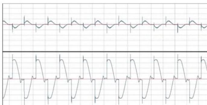
Bild 7: Darstellung des Stroms (oben) und der Spannung (unten) bei der Phasenanschnittsteuerung eines induktiven Verbrauchers (Motor)
