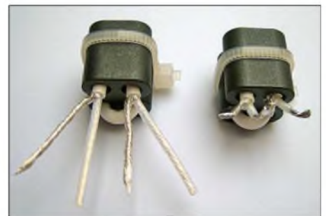
Bild 15: Die Kabelenden sind nun weiter abzuisolieren und zu kürzen.
