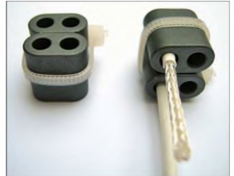
Bild 13: Erste Windung des an den Enden 21 mm vom Außenmantel befreiten 25-Ω-Kabels
