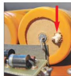
Bild 2: Teilweise tritt sogar das Elektrolyt an den defekten Stellen aus.
