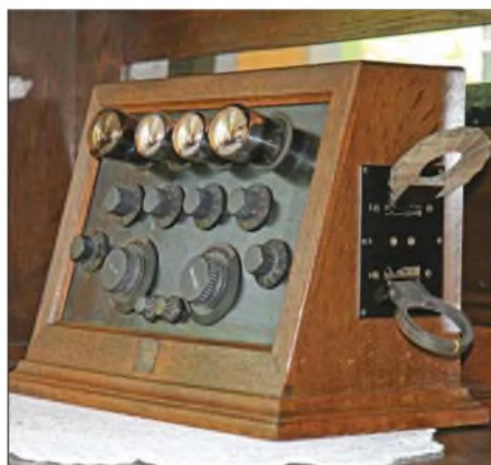
Bild 2: Seibt EL 27 von 1926, mit von außen zugänglichen, auswechselbaren Spulensätzen
