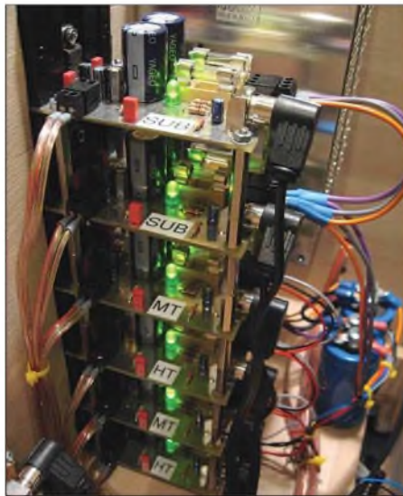
Bild 11: Die sechs Verstärkermodule werden mit Distanzrollen übereinander verschraubt.
