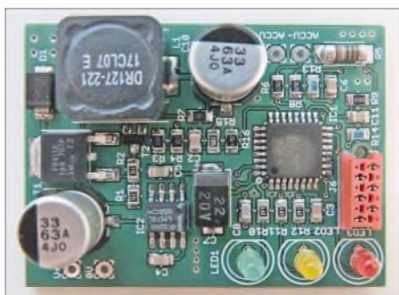
Bild 1: Ansicht der komplett bestückten Leiterplatte des Ladecontrollers Fotos: DG8CAJ
