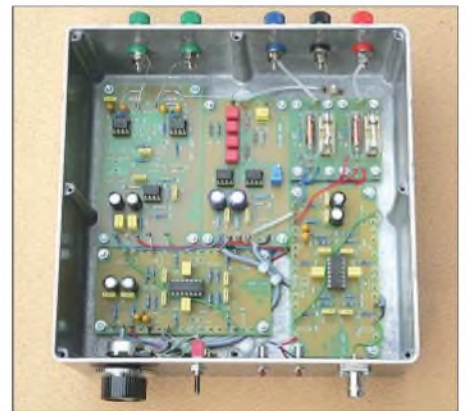
Bild 12: Messverstärker für die in Bild 11 gezeigte Spule Fotos: DG9WF
