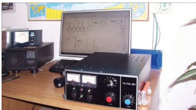
Bild 1: GU-50-Endstufe betriebsfertig auf dem Stationstisch
