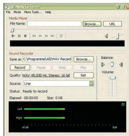
Bild 7: Im Hauptfenster des Recorder-Programms All2WAV lassen sich die Aufnahme steuern und ihre Qualität festlegen.
