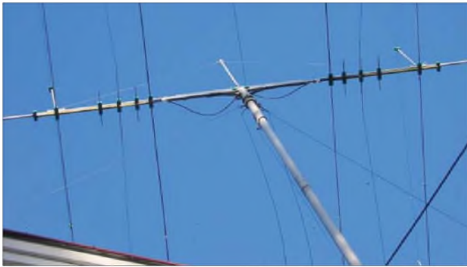
Bild 4: Ansicht der Antenne unter dem finnischen Himmel; gut sind die zweimal drei Elemente zu erkennen. Die für 15 m bestehen lediglich aus einem Rohrmittelstück mit anschließendem, abgespanntem Draht.
