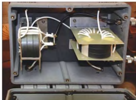
Bild 2: Baluns zur Anpassung der Sendean-tenne
