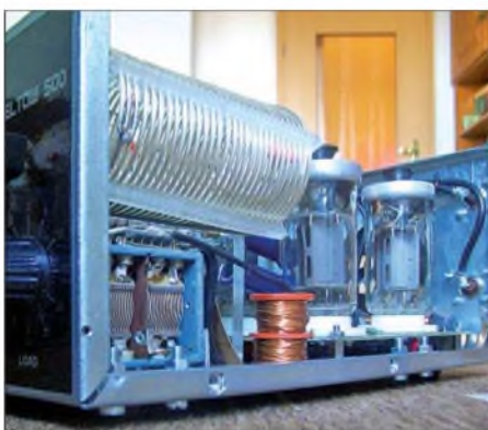
Bild 5: Blick auf das HF-Teil; oben L4, links unten C5, daneben die unabdingbare Sicherheitsdrossel L5 parallel zum Antennenausgang Fotos: DH1TST
