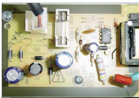
Die auf der Platine erkennbaren Einsparungen sprechen geltenden Sicherheitsbestimmungen Hohn und sind Anlass für breitbandige Funkstörungen. Foto: DB1NV
