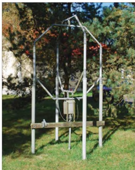
Bild 4: Vier solcher gekreuzten Rahmenantennen empfangen die reflektierten Signale aus der Ionosphäre.
