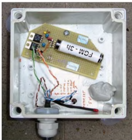
Bild 2: Der eigentliche Sensor in seinem Kunststoffgehäuse Fotos: DJÖBI
