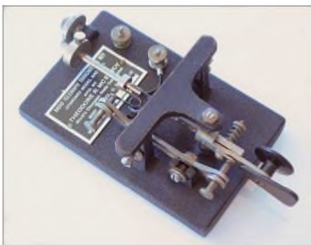
„Mac-Key Standard“, halbautomatische Morsetaste von 1939, Metallteile vernickelt, Preis damals 7,50 US-$; Aufnahme von Adam Nathanson, N4EKV
