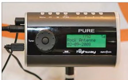
Pure Highway sendet das decodierte DAB-Signal auf einer freien UKW-Frequenz ans Autoradio. Fotos: DL1ABJ
