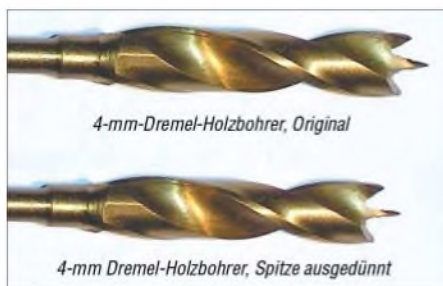
Bild 3: Dremel-Holzbohrer, oben un bearbeitet, unten bearbeitet
