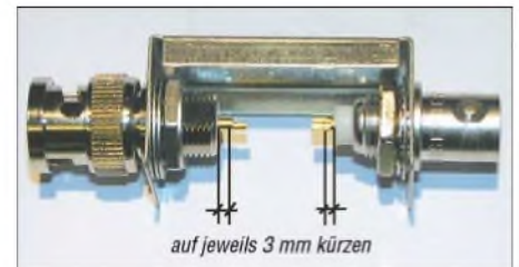
Bild 6: Schritt 1: Montage der HF-Anschlüsse
