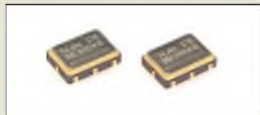
Die Si570 wird es demnächst bei uns auch für Frequenzen bis 810 MHz geben.
