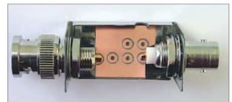
Bild 7: Schritt 2: Probeweises Einsetzen der unbestückten Platine, Anfertigung der Aussparung für den Durchführungskondensator
