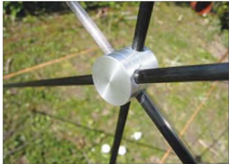
Bild 9: Selbst gefertigtes Leichtmetall-Mittelstück des Spreizers
