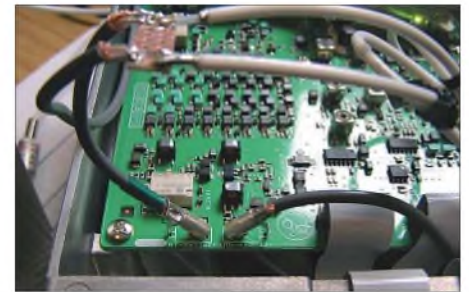
Bild 4: Platine zum Herstellen der Verbindung zwischen den Kabelenden Fotos: DK4WW
