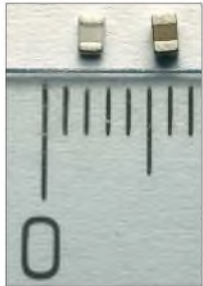
Bild 12: Klein und namenlos; keramische SMD-Kondensatoren tragen oft keine Beschriftung. Auch die Abmessungen lassen keinen Rückschluss auf die Kapazität zu (der linke Kondensator hat 1 pF, der rechte 2,2 pF).
