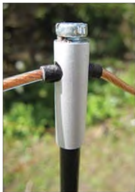
Bild 10: Leichtmetall-Klemme am Spreizerende (leicht mit Erde verschmutzt); die Drahtisolation ist mit Gewebeband geschützt.
