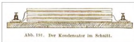
Bild 3: Ansicht des zusammengesetzten Kondensators im Schnitt
