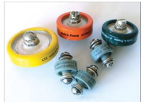
Bild 11: Verschiedene Ausführungen keramischer Kondensatoren für Leistungsanwendungen Fotos: DJ3TZ
