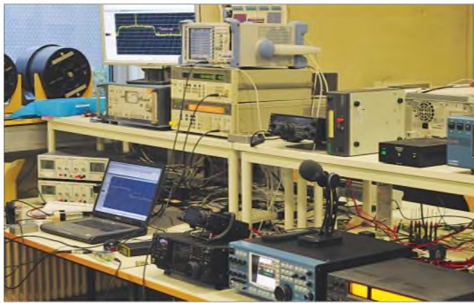
Bild 2: Alt gegen neu – wer ist der Großsignalfestere? Oben Telefunken E1800/3, unten Icom IC-7700
