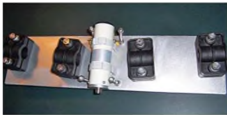
Bild 4: Masthalterung mit Balun; die Elementhalter sind leicht V-förmig angeordnet.
