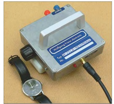
Bild 8: Hier detektiert das H-Feld-Messmodul die magnetischen Impulse, die von dem Anker der Armbanduhr ausgesendet werden. Fotos und Screenshots: DG9WF
