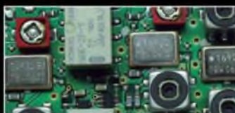
1. ZF: Drei Roofing-Filter bei 69,45 MHz
