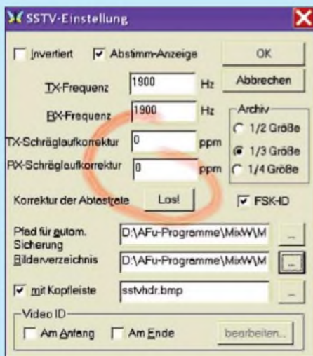
Bild 16: Abgleich der Soundkarte
