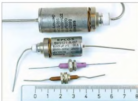
Bild 23: Verschiedene Ausführungen von Durchführungskondensatoren
