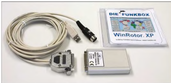
Bild 1: WinRotor-Hard- und Software frisch ausgepackt; hier die Ausführung WinRotor USB Interface Sat [1]
