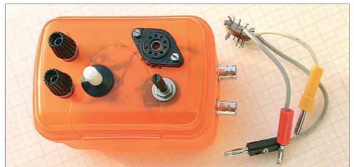
Bild 1: Ansicht des fertigen Prüfgeräts mit dem Adapter zum Kontaktieren größerer Bauelemente Fotos: Koch
