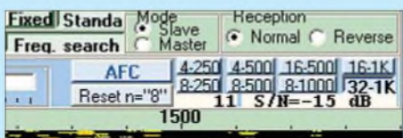
Bild 7: Olivia-Betriebsparameter in MultiPSK
