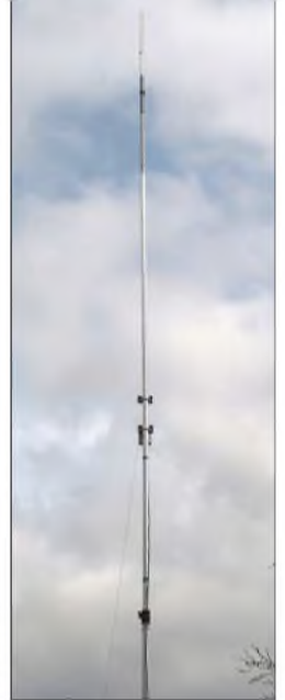
Bild 7: Sperrkreis-Vertikalantenne beim Abgleich
