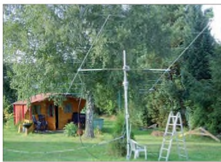
Vier Wochen vor dem Start der gemeinsam mit Frank, DH7FB, für den 17. bis 21.10.08 geplanten EME-Aktivität von Guernsey hatte Bernd, DF2ZC, die zwei Neunelement-M 2 im Garten zum Test aufgebaut. Mit der Station im Gartenhaus glückten einige EME-QSOs. Foto: DF2ZC
