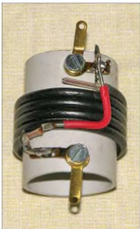
Bild 6: Sperrkreis für 28,4 MHz aus Koaxialkabel RG174
