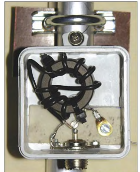
Bild 3: Praktische Ausführung des Baluns in der Anschlussdose am Strahler
