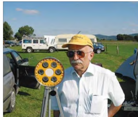
Peter, DL7UHU, und sein Eigenbaugerät zur Justage von Lichtsprechgeräten, mit Tripelprismen und Sender für 348 und 455 THz.
