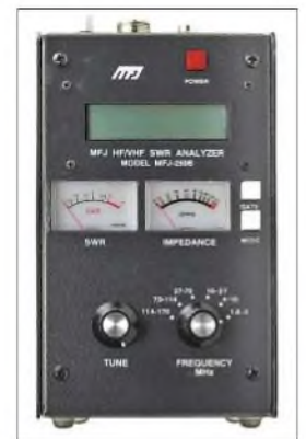
Bild 20: Das eigentlich für Antennenmessungen gedachte MFJ-259B eignet sich auch zum Messen der Resonanzfrequenz von Kondensatoren. Fotos: DJ3TZ
