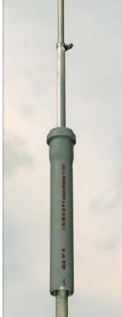
Bild 9: Das übergeschobene HT-Rohr schützt den Sperrkreis.
