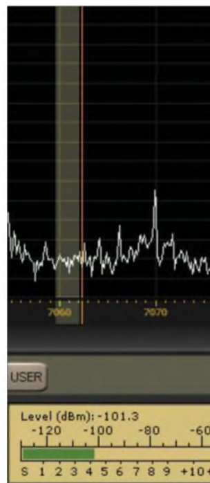
Bild 4: ... der sich beim Wechsel zur Magnetantenne auf S4 reduziert. Jetzt sind auch vormals im Rauschen versunkene Signale sicht- und hörbar. Bilder: DL1ABJ
