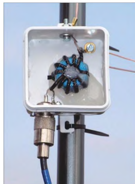
Bild 10: Anschlussdose der Angelrutenvariante der Antenne Fotos: DK7ZB
