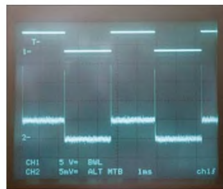
Bild 4: Relevante Signale auf dem Oszilloskop; oben das Referenzsignal, unten das Wechselspannungsausgangssignal bei 50 \mu\text{V} Eingangsspannung und einer Verstärkung von 100; C_2 = 330 \text{ pF} Screenshot: Franke
