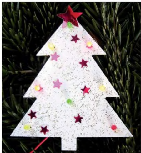
Die Platine des bekannten Weihnachtsbäumchens AS017 ist bereits ausgefräst und braucht nur noch bestückt zu werden. Allerdings lädt der Bausatz zu kreativem Gestalten ein. Foto: AATiS
