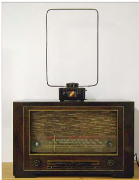
Bild 7: Röhrenaktivantenne auf einem Empfänger D770WK Fotos: DB1NV
