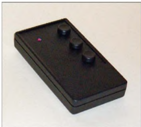
Bild 1: Das persönliche Morse-Notizbuch findet, zusammen mit zwei Batterien, in einem Data-Pocket-Gehäuse bequem Platz.
