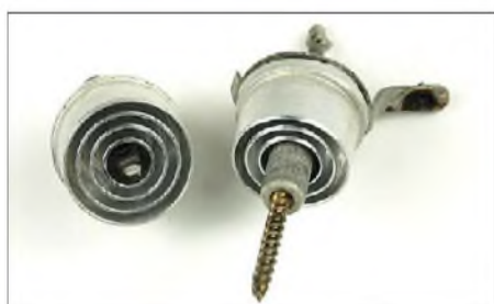
Bild 49: Hauptbestandteile des Lufttrimmers aus Bild 48
