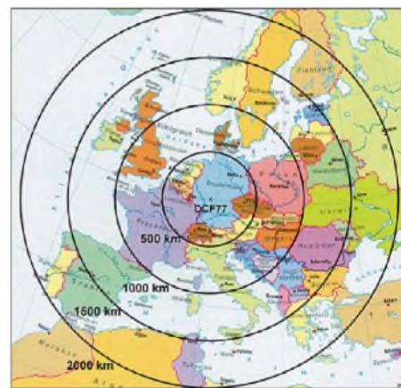
Bild 2: Das DCF77-Signal erreicht Empfänger im Umkreis bis 2000 km. Bilder: PTB
