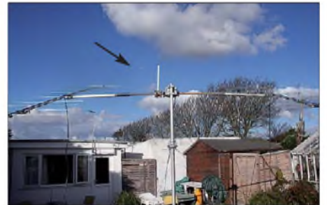
Sauber aufs Ziel ausgerichtet: Die zwei Neunelement-Yagis in Guernsey
