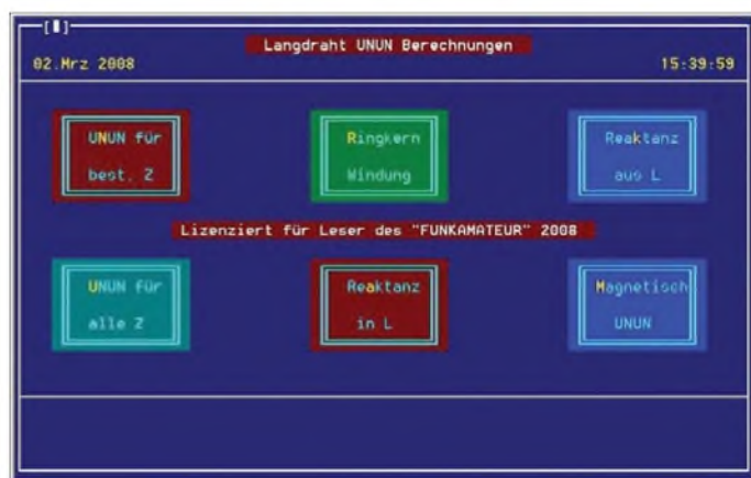
Bild 6: Hauptmenü des Programms Balun.exe; links die Funktionen für die Berechnung des Unun als HF-Transformator, in der Mitte oben Ringkernberechnung; dann Umrechnungen der Reaktanzen in Induktivitäten und umgekehrt sowie rechts unten die Berechnung des „Magnetischen Unun“
