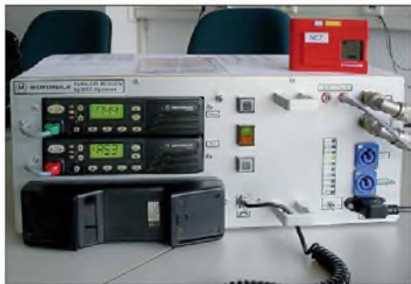
Der Funkkoffer (Fuko270) ist eine Eigenentwicklung von Notfunk-Deutschland e. V. zum Betrieb im Stabsraum einer BOS-Leitstelle. 2-m-Pager werden zur Alarmierung von Notfunk-Deutschland-Einsatztrupps eingesetzt. Fotos: DG1FDV
