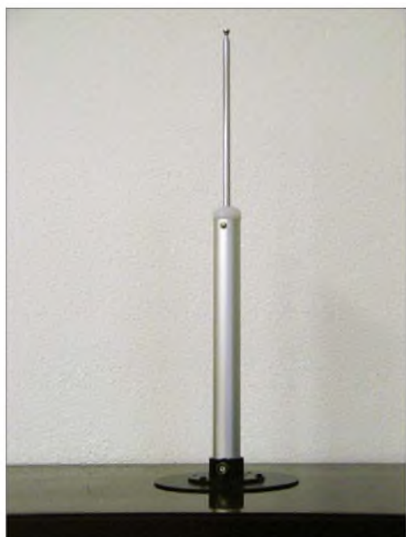
Bild 9: Antennenstab einer Aktivantenne mit Operationsverstärker nach Bild 10
