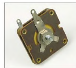
Bild 41: Die Kontaktierung des Rotors erfolgt mittels Mutter und federnder Kontaktlasche.
