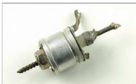
Bild 48: Außenansicht eines zusammenschraubten Lufttrimmers
