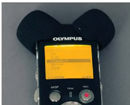
Bild 2: Das Display hat auch eine Hintergrundbeleuchtung für Nachtaufnahmen. Hier zu sehen: die weniger empfehlenswerte DSP-Einstellung des Mikrofons.
