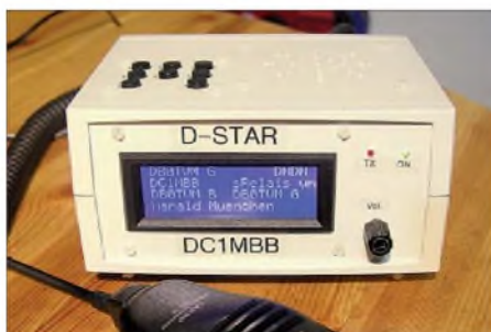
Aufbauvariante von Harald Schmid, DC1MBB, basierend auf einem Standardgehäuse Typ BOPLA U 160, 160 x 75 x 133 mm 3 , grau (Bezug: Reichelt Elektronik); leider ist dieses Gehäuse nur aus Kunststoff, aber dafür passt es fast wie maßgeschneidert, Einstrahlungsprobleme oder Störsignale vom Adapter sind nicht aufgetreten. Foto: DC1MBB
