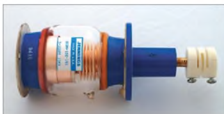
Bild 51: Vakuumdrehkondensator von Jennings mit 5 bis 100 pF und einer Spannungsfestigkeit von 15 kV
