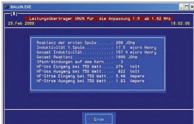
Bild 9: Rechenergebnis für den Leitungsübertrager 1:9 in Bild 8
