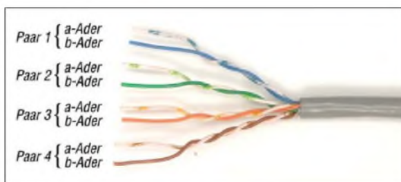
Bild 6: Netzwerkkabel nach EIA/TIA-568B
