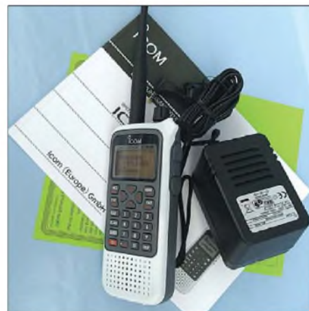
Bild 7: Außer dem eigentlichen Empfänger mit seiner Antenne befinden sich im Lieferumfang noch ein Steckernetz-/ladegerät, ein Gürtelclip, eine Handschlaufe und eine deutschsprachige Anleitung.
