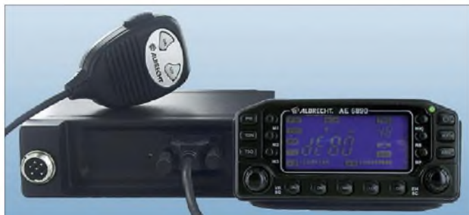
Bild 1: Ein CB-Mobilfunkgerät nicht nur für den Kleinwagen: Das Bedienteil des Albrecht AE 6890 ist abnehmbar.
