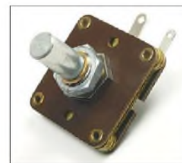
Bild 40: Einfachdrehkondensator mit Folie als Isolator
