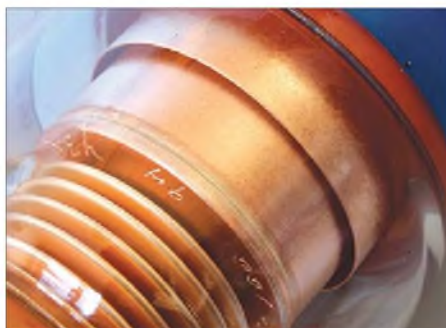
Bild 52: Konzentrischer Zylinder des Vakuumdrehkondensators aus Bild 51
