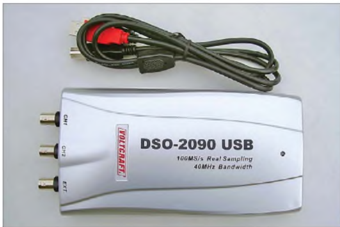
Bild 1: Blick auf das handliche digitale Speicheroszilloskop Voltcraft DSO-2090USB; an der Frontseite befinden sich die BNC-Buchsen beider Kanäle und des externen Trigger-signals.
