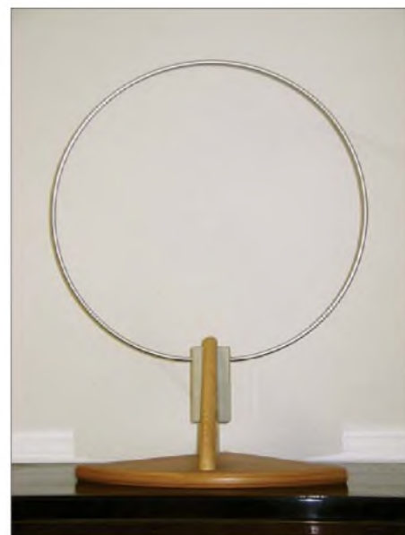
Bild 11: Ansicht der Schleifenantenne der Aktivantenne mit OPV nach Bild 12
