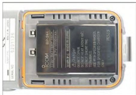
Bild 4: Auch das Akkumulatorfach ist gut abgedichtet.
