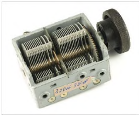
Bild 33: Typischer Luftdrehkondensator aus einem Röhrenradio
