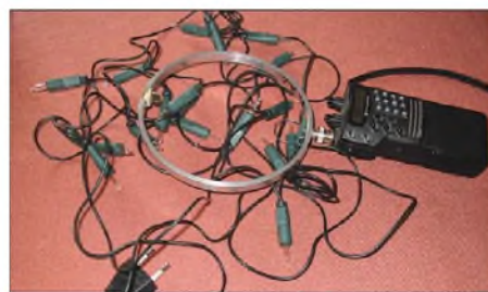
Gute Ergebnisse hat DL8ZX mit der früher einmal vom FA-Leserservice vertriebenen 2-m-Loopantenne sowie mit einer HB9CV auf 70 cm erreicht, da diese räumlich kleinen Antennen die HF konzentriert abstrahlen.
