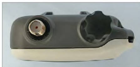
Bild 2: Neben der SMA-Buchse zum Antennenanschluss befindet sich der Hauptabstimmknopf.
