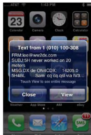
Bild 9: Screenshot E-Mail Alert; so sieht ein DX Alert auf dem iPhone aus. Die Meldung erscheint direkt auf dem Eröffnungsbildschirm.
