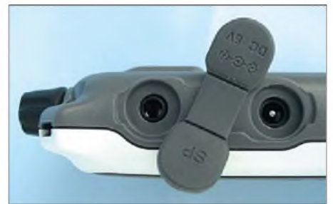
Bild 3: Auf der rechten Seite liegen die Anschlussbuchsen.
