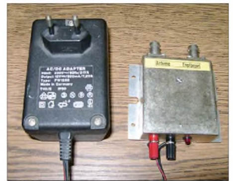
Bild 14: Die Fernspeisung nach Bild 13 ist in ein geschirmtes Gehäuse einzubauen.
