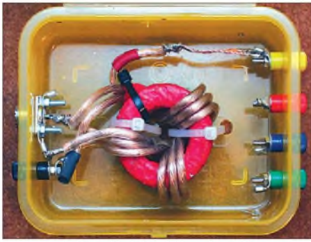
Bild 8: Der gleiche Kern, diesmal als Leitungsübertrager 1:9 mit dickem Draht gewickelt, sowie ohne Anzapfungen
