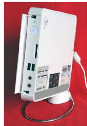
Bild 2: USB-Schnittstellen sowie Buchsen für Kopfhörer und Mikrofon sind hinter der Frontklappe zugänglich.
