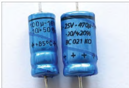
Bild 54: Die Toleranz der Kapazität ist bei Elektrolytkondensatoren oft groß, links von -10 bis +50 %, rechts von -20 bis +20 %.
