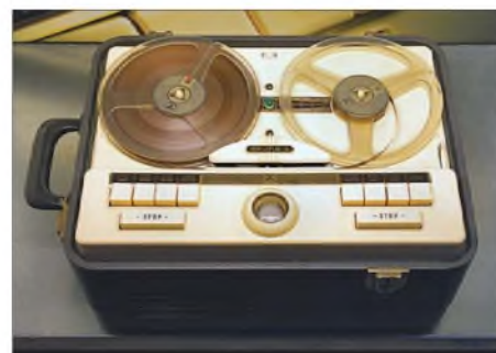
Grundig „Reporter“ – der von Kurt Bier entwickelte Urahn der Grundig-Tonbandgeräte
