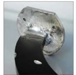
Bild 2: An das Ende eines Aluminium-Hohlleiters wurde mit AL75 eine Montageplatte gießliert.
