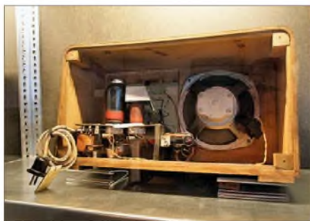
Radiobauteil „Heinzelmann“ aufgebaut, von hinten
