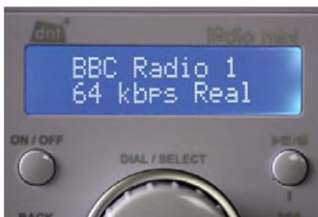
Bild 4: Die BBC überträgt ihre Inlandsprogramme im Format Real Audio. Die untere Displayzeile nennt die Übertragungsrate und das Datenstromformat.
