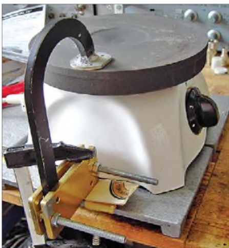
Bild 1: Die Werkstücke wurden vor dem Erhitzen mit einer Kochplatte (Hilfsheizung) und mit einem 500-W-Elektrolötkoben (nicht im Bild) sorgfältig fixiert. Vorsicht: Alles wird sehr heiß und die Abkühlung dauert recht lange!
