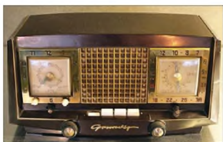
Der „Heinzelmann 2“ von 1953 mit eingebauter Synchronuhr dürfte der Vater aller Radio-wecker sein.
