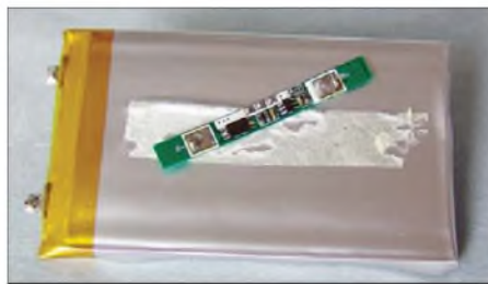
Bild 13: Vorbereitete Einzelzelle; sie war im ursprünglichen Gehäuse mit einem Klebestreifen fixiert. Die Schutzschaltung ist bereits entfernt.
