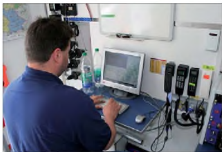
DG1FDV beim Konfigurieren des APRS-Empfängers am 2. Arbeitsplatz der mobilen Funkeinheit; rechts: Mobiltelefon (D-Netz), die Handapparate der 2-m- und 70-cm-Geräte
