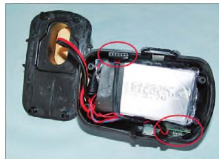
Bild 18: Die Anordnung der Komponenten im Akkumulator-Gehäuse. Der LiPo-Wächter sollte auf der Seite montiert werden, auf die man beim Arbeiten sehen kann, also für Rechtshänder links. Fotos: Hermes
