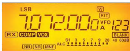
Bild 2: Das Display signalisiert über seine Icons auch die wichtigsten Schaltzustände. Die Menübezeichnungen ersetzen ggf. Frequenz und Speicherkanalnummer.
