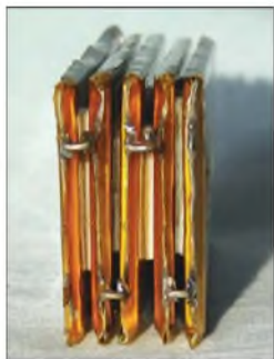
Bild 15: Das Verlöten der Akkumulatorzellen zum Pack erfolgt mit ausreichend dicken Verbindungsstücken und reichlich Lötzinn.
