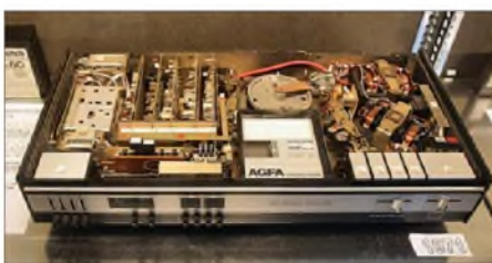
Zur Funkausstellung 1971 kam dann das „VCR“-Kassettsystem mit besserer Bildqualität und ohne das Einfädelproblem der Spulen-Videorecorder. Die in den VCR-Kassetten übereinander statt nebeneinander liegenden Spulen sorgten allerdings oft für Bandklemmer.
