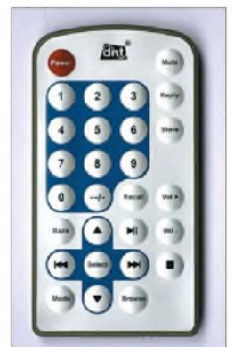
Bild 2: Der kompakte Webweltempfänger lässt sich auch per Infrarot-Fernbedienung steuern – bei allerdings begrenzter Reichweite. Ein Großteil der Stationspeicher ist nur auf diesem Weg zugänglich.
