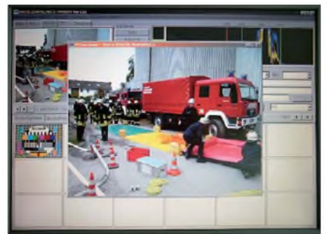
Anzeige des SSTV-Programms im Nebenraum der BOS-Leitstelle. Der Rechner war an das lokale Netz angeschlossen, sodass die Einsatzbearbeiter der BOS-Leitstelle über das vorhandene Netzwerk die Bilder sichten konnten. Fotos: DG1FDV
