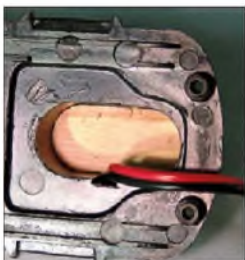
Bild 12: So lassen sich die Akkumulatorkontakte im Gehäuse fixieren.
