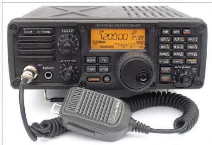
Bild 1: Frontansicht des IC-7200. Unverkennbar seine gestalterische Ähnlichkeit mit kommerziellen Geräten für den ortsveränderlichen Einsatz. Oben rechts vorfindet sich der Lufteinlass für die Endstufe, darunter liegen schräg die beiden Lüfter; der hintere Teil der oberen Plastikgehäuseschale ist zur Luftführung geschlossen.
