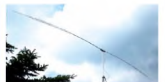
Duoband-Rotary-Dipol CX 3040 RD Abb ohne Abspannung, Gesamtlänge 15,52 m
