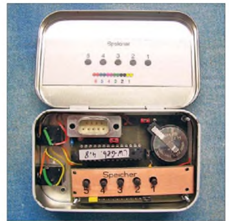
Bild 2: Externe Variante des Morsegebers in einer Pastillendose
