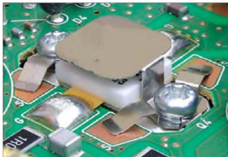
Bild 6: Interessantes Detail: die induktivitätsarme Emitter-Masseverbindung bei den Endstufentransistoren
