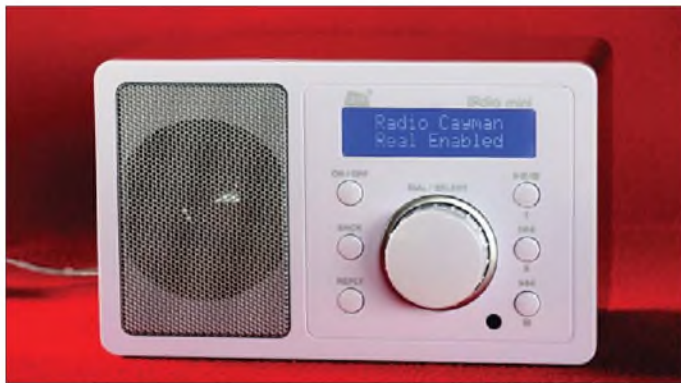
Bild 1: Der IPdio mini empfängt Radiosender aus aller Welt per Internet. Der zentrale Steller dient zur Navigation im Bedienmenü und beim Empfang zur Lautstärkewahl.
