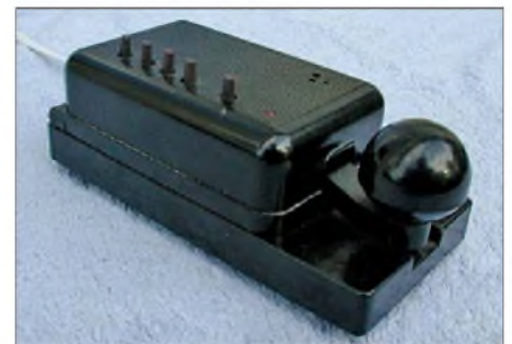
Bild 3: Platz sparende Unterbringung des Morsegebers in einer Morsetaste
