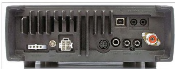
Bild 3: Rückansicht des IC-7200. Auffallend sind die seitlichen Puffer, die ein hochkant abstellen gefahrlos möglich machen; links der Luftauslass
