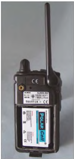
Bild 9: Passt genau rein – kräftiger Akkumulator eines Mobiltelefons im Handfunkgerät als Alternative zu NiCd-Akkumulatoren
