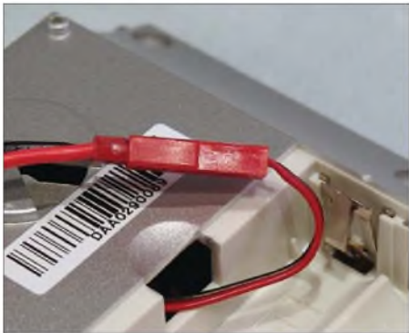
Bild 8: Solch ein BEC-Steckverbinder erlaubt den schnellen Anschluss ans Ladegerät.
