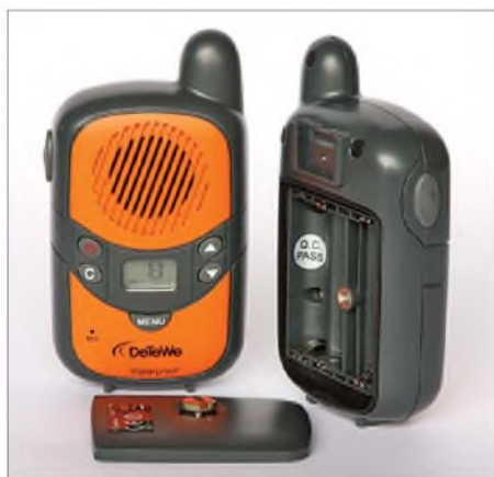
Bild 1: Das DeTeWe Outdoor 2000 ist ein einfaches PMR446-Handsprechfunkgerät, dessen robuster und wetterfester Aufbau es für den Einsatz etwa im Winterurlaub empfiehlt.
