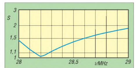
Bild 16: Simulierter SWV-Verlauf der 10-m-Moxon-Antenne, Entwurfsfrequenz 28,2 MHz
