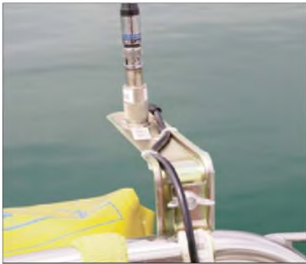
Bild 6: Nahaufnahme der Befestigung für die UKW-Antenne
