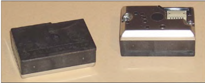
Bild 1: Staubdetektoren gibt es fertig auf- gebaut von Sharp.
