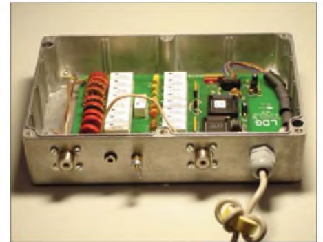
Bild 7: Das automatische Antennenanpassgerät in einem Aluminiumgehäuse
