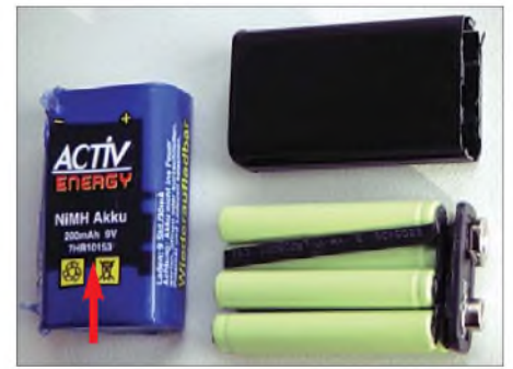
Bild 4: 9-V-Akkumulator mit irreführender IEC-Bezeichnung; die richtige Bezeichnung wäre entsprechend Aufbau 7HR 7/42 .
