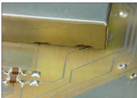
Bild 19: Aussparungen vermeiden Kurzschlüsse.
