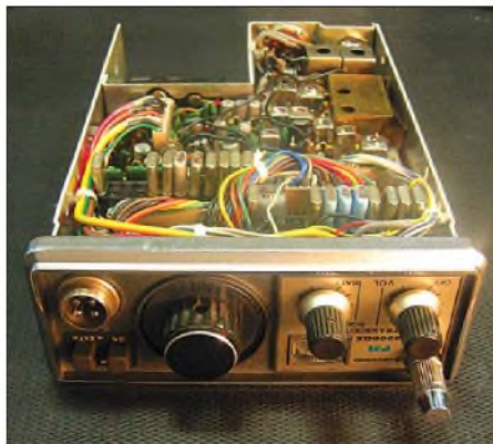
Bild 2: Blick auf die Unterseite des geöffneten TR-2200GX im Originalzustand, im Vordergrund die beiden Reihen Send- und Empfangsquarze
