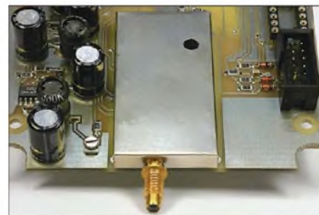
Bild 17: Abschirmung des Analogteils
