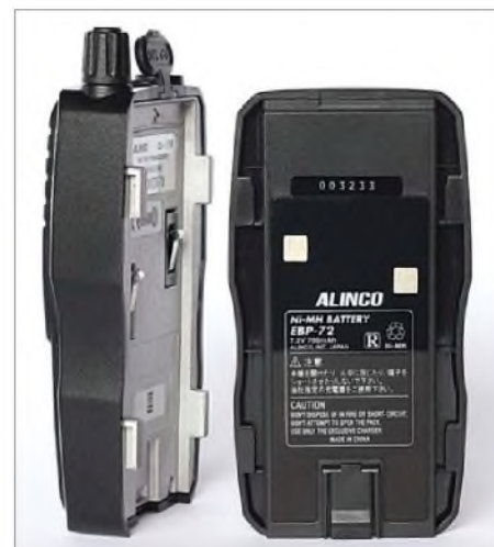
Bild 4: Der mitgelieferte NiMH-Akkumulator belegt die komplette Rückseite des DJ-175E.
