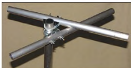
Bild 13: Die Mittelspinne besteht aus Aluminiumrohren.
