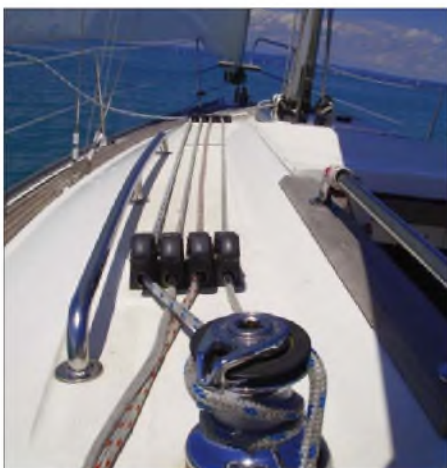
Bild 3: Ähnlich einem Kabelbaum sind auf einem Segelboot zahlreiche Leinen zum Bedienen der Segel verlegt.
