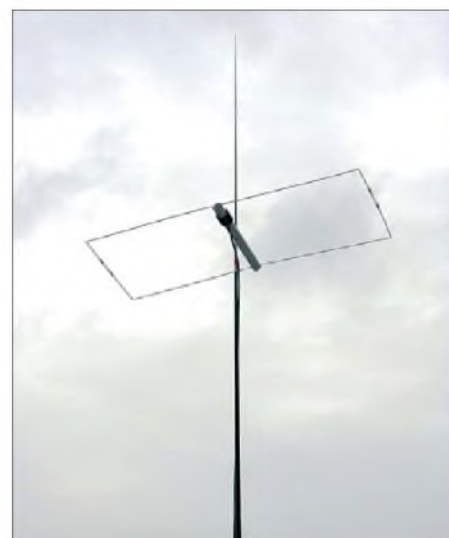
Bild 4: 2-m-Moxon-Beam aus Aluminium-Schweißdraht mit einer Angelrute als Mast
