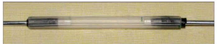
Bild 9: Die zur Stabilitätsverbesserung mit einem Isolierstück verbundenen Enden
