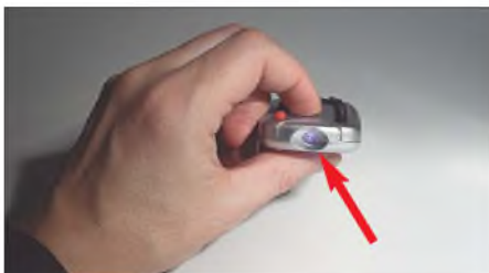
Die Telegramme der IR-Fernbedienung sind gut auf dem Display eines Mobiltelefons mit Kamerafunktion zu sehen. Foto: Red. FA
