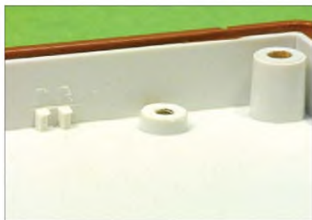
Bild 25: Abgefräste Auflageflächen für die Leiterplatte im Pultgehäuse
