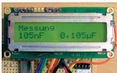
Bild 9: Display mit Messwertausgabe im Nano- und Mikrofarad-Bereich Fotos: Bolle
