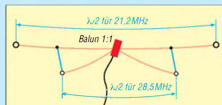
Bild 24: Prinzip eines offenen Multiband-Dipols; Startwerte für den Abgleich sind die Maße von Monoband-Dipolen. Weitere Beispiele in [3].
