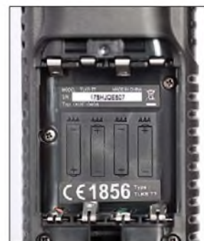
Bild 3: Das Batteriefach fasst alternativ zum mitgelieferten Akkumulatorpaket vier AAA-Zellen (Micro).
