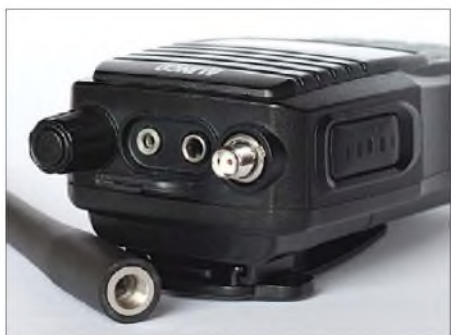
Bild 3: Auf der Oberseite liegen die Buchsen zum Anschluss der Antenne sowie eines Lautsprechermikrofons. Ein rastender Drehknopf ergänzt die Bedienelemente auf der Frontseite.
