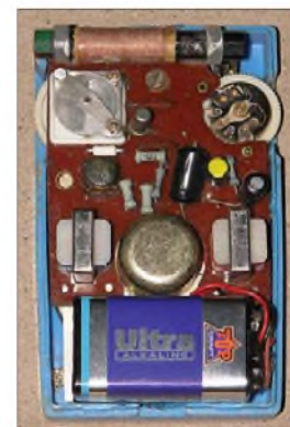
Bild 15: Das „miniaturisierte“ Innenleben des Zweittransistor-Reflexempfängers Fotos: DK7ZB
