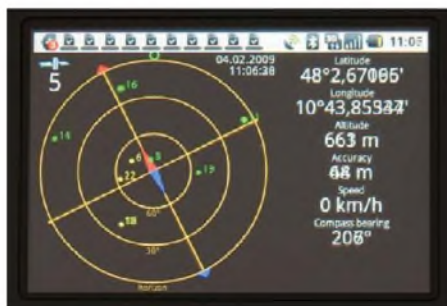
Bild 2: GPS-Status zeigt Zahl und Orte der empfangbaren GPS-Satelliten sowie die genaue eigene Position (Breite, Länge, Höhe).
