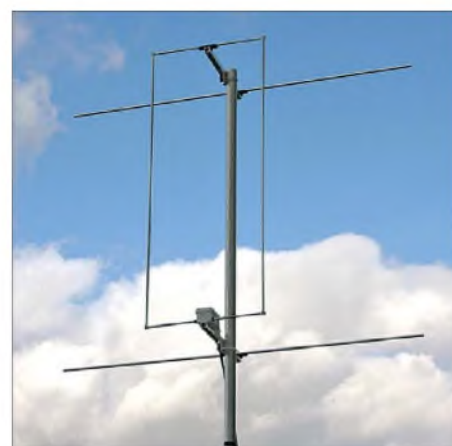
Bild 5: Fertig aufgebautes 2-m-Quadlong
