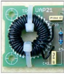
Bild 13: Zur Schleifenkopplung, hier beispielhaft ein Teil der Platine UAP21 [12], lässt sich der Schleifendraht ein- bis zweimal durch den Ringkern führen.
