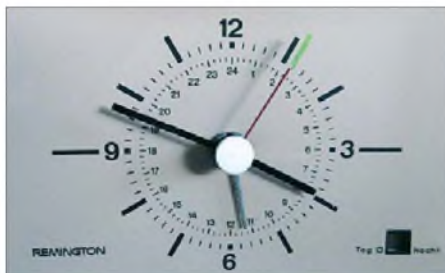
Bild 8: Netzfrequenzabhängige 50-Hz-Synchronuhr mit Leuchtfolie auf dem Zeiger
