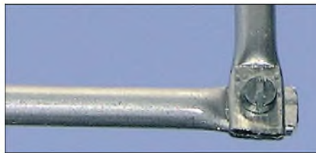
Bild 7: Eckverbindung der 6-mm-Rohre bei dem 2-m-Quadlong
