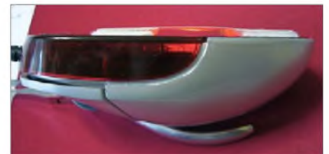
Bild 6: Zwischen Membran und Maus ist etwas Platz zu lassen. Fotos: Autor
