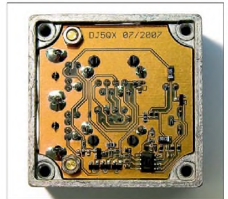
Bild 4: Blick auf die Lötseite der Platine mit den aufgelöteten SMD-Bauelementen
