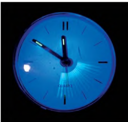
Bild 5: Langzeitaufnahme des Sekundenzeigers einer Quarzuhr
