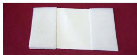
Bild 3: Vorbereitung der Membran mit zwei Klebstreifen
