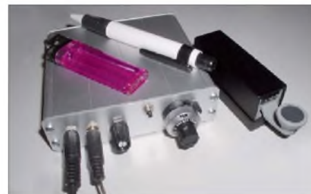
Portabelgeräte baut man selbst: Der BCR-Spezial (oben) ist ein QRP-Transceiver von Con, DM5AA. Mosquita (unten) ist mein persönlicher Ultra-Portabel-Transceiver für den Rucksack. Fotos: DL2FI
