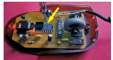
Bild 7: Bei der hier verwendeten Maus war das NF-Signal an einem IC abgreifbar.
