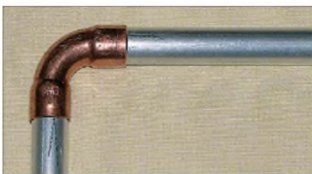
Bild 11: Eckverbindung mit Kupferrohr-Fittings (Baumarkt) bei der 6-m-Antenne
