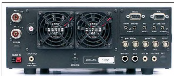
Bild 2: Die Ansicht der Rückfront des K3 hängt von seiner konkreten Ausstattung ab. Auch bei unserem Muster sind noch zwei potenzielle Buchsen abgedeckt. Die Stromversorgungsbuchse hat einmal wieder eine andere Form.
