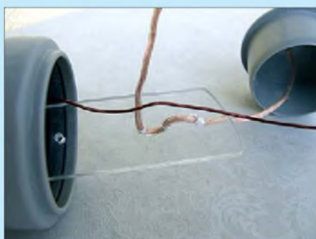
Bild 34: Detailsansicht der innerhalb des Spulenkörpers untergebrachten Zugentlastung; der Antennendraht wird durch die drei Löcher geführt und anschließend mit einem Ende der Spule verlötet
