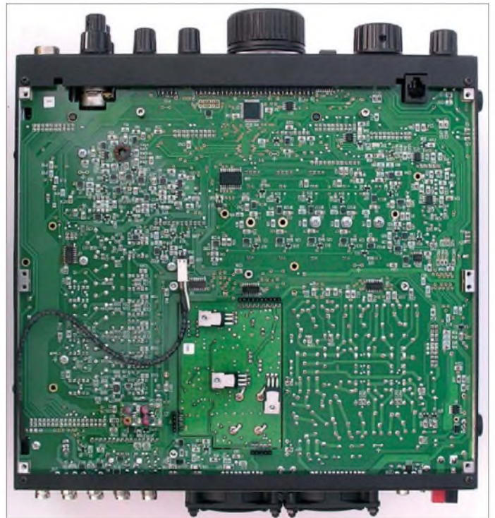
Bild 3: Ansicht von oben in das geöffnete Gerät. Der modulare chassislose Aufbau ist gut zu erkennen. Unten die Senderendstufe mit ihren beiden Lüftern, links der Antennentuner
