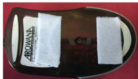
Bild 4: Die Gegenstücke des Klebstreifens kommen auf die Mausunterseite.
