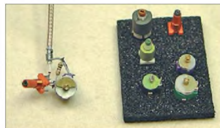
Bild 8: Anpassung des 1-kΩ-Widerstands mit Paralleltrimmer und Serienspule; für weitere Anpassungen stehen verschiedene Messspulen und Trimmer zur Verfügung.
