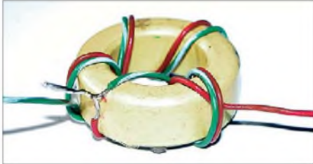
Bild 1: Auskoppelwicklung L3 mit zweimal 4 Wdg., hier exemplarisch über den ganzen Kern verteilt; im Endeffekt nehmen die Windungen nur einen kleinen Teil des Kernumfangs ein. Fotos: DL8OL
