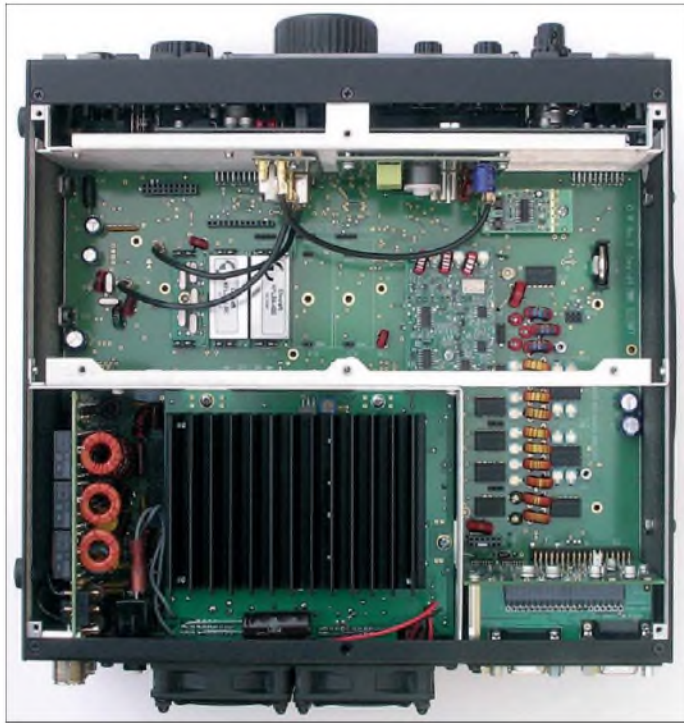
Bild 4: Innensicht von unten mit der Hauptleiterplatte. Im Ausschnitt die K3-Low-Power-Amplifier-Leiterplatte. Oben eine Western-Buchse (FP ACC) für „Fabrikeinstellungen“
