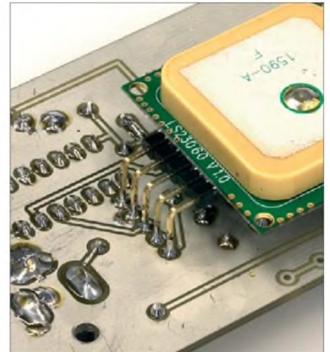
Bild 7: Die kurzen Stifte der gewinkelten Stiftleiste tragen das GPS-Modul, die langen Stifte stellen die Verbindung zur Platine her. Fotos: DH8BQA (1), Red. FA (3)
