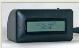
Als Gehäuse für den GPS-Empfänger mit Locatoranzeige lassen sich sowohl das angebotene, bearbeitete Gehäuse als auch andere nutzen.
