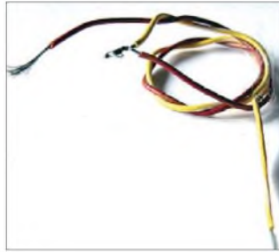
Bild 2: Auskoppelwicklung L2 mit zweimal 2 Wdg. für die Luftspulenvariante
