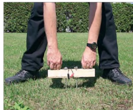
Bild 4: An den Holzleisten sind Griffe befestigt, an denen die Sonde wieder aus dem Erdreich gezogen werden kann.
