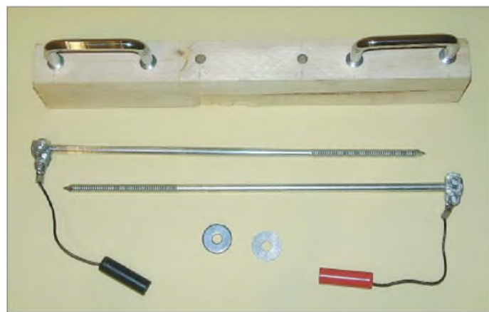
Bild 3: Bei einer zweiten Erdsonde fanden 280 mm lange und 6 mm dicke Sparrennägel als Erdspieße Verwendung.
