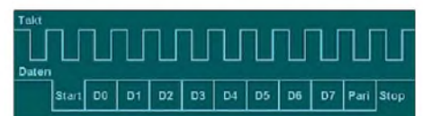
Bild 3: Oszilloskopdarstellung des Scancodes einer PS/2-Tastatur
