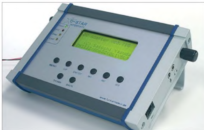
Bild 1: Frontansicht des DV-Adapters 2.0; die durch einen Aufstellbügel bewirkte Schrägstellung ermöglicht eine bequemere Bedienung.
