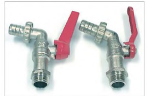
Bild 16: Zwei geöffnete Kugelauslaufhähne; der linke wird (ungewohnt) durch Linksdrehung geschlossen, der rechte durch Rechtsdrehung – zu erkennen an der Nase am Korpus und an der Aussparung am Knebel.
