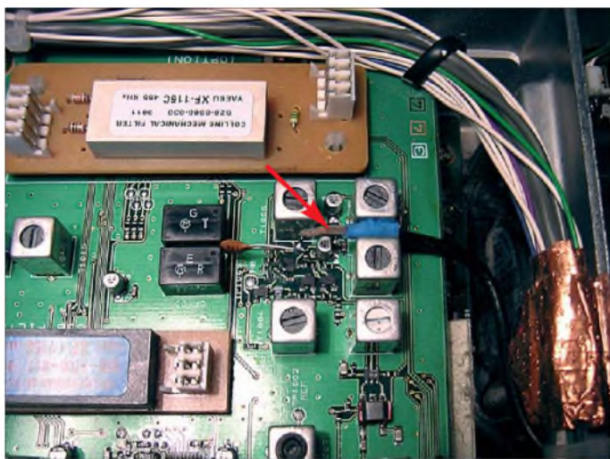
Bild 12: Signalauskopplung beim FT-847
