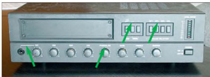
Bild 13: Bei diesem Verstärker wurden die Bedienelemente und Buchsen korrekterweise durchweg oberhalb mit Beschriftung versehen, siehe grüne Pfeile.
