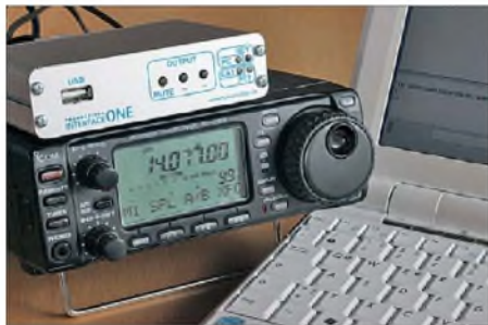
Bild 1: Eine komplette Station für HF-E-Mail mit PSKmail; lässt sich die PTT des verwendeten Transceivers per VOX steuern, reicht auch ein Soundkarteninterface ohne CAT (Fernsteuerung des TRX über den PC).
