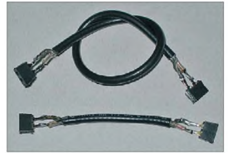
Bild 12: Diese beiden Adapterkabel dienen zur einfachen Prüfung aller Stufen während der Aufbauphase und helfen bei der schnellen Fehlereingrenzung.
