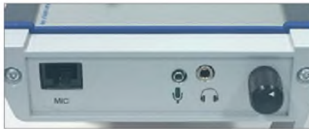
Bild 7: An der rechten Seite kann entweder ein Mikrofon mit Westernstecker (Icom HM-103, Yaesu MH31A8J o. a.) oder eine Hör-/Sprechgarnitur bzw. ein Lautsprechermikrofon (z. B. Wimo MS-109) angeschlossen werden.
