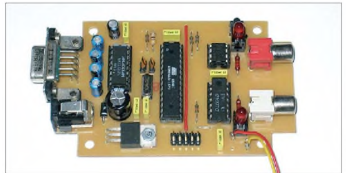
Bild 2: Auf der einseitig kaschierten Platine befinden sich alle Bauteile. Lediglich der Taster ist über zwei Adern anzuschließen.
