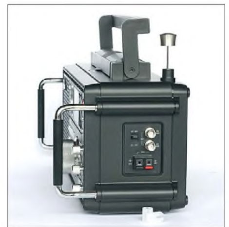
Seitlich liegen BNC-Buchsen zum Anschluss externer Antennen; die eingebaute Teleskopantenne lässt sich per Schalter deaktivieren. Der ausklappbare Bügel erleichtert den Transport.
