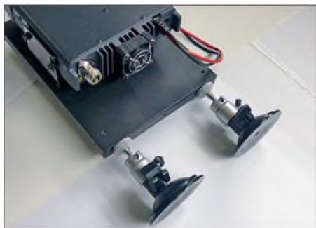
Bild 5: Halteplatte mit zwei solide befestigten Hama-Stativen Fotos: DL2GLS
