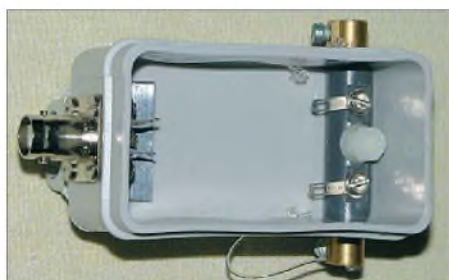
Bild 7: Innenansicht der Anschlussdose des Strahlers von DH6RM
