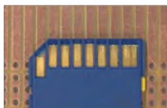
Bild 4: Als Adapter eignen sich auch Universalplatinen mit Steckkontakten.
