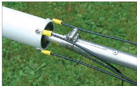
Bild 4: Befestigung der Seitenstrahler an der Ladespule
