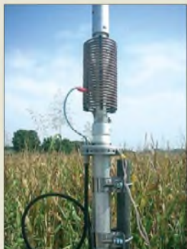
Die Spule am Fußpunkt der EV80 besitzt Abgriffe für den Abgleich der Antenne.
