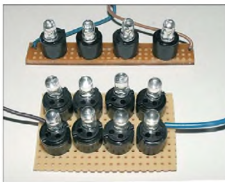
Ansicht der beiden mit weißen LEDs aufgebauten Lampen Foto: DG1VR
