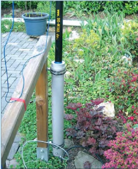
Bild 51: Das untere Ende seiner rückgefalteten Vertikalantenne hat DC1DV an einem Geländer befestigt. Bemerkenswert ist der Mastfuß aus DN75er HT-Rohr (Baumarkt), der dem 12,3-m-GFK-Mast wesentlich mehr Stabilität verleiht als ein Wäscheständer-Schraubfuß.
