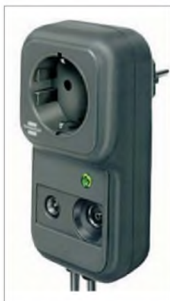
Bild 9: Ein Überspannungs-Schutzgerät für Teilnehmer-Endgeräte, hier SP Koax von Brennenstuhl, schützt das Gerät sowohl netz- als auch antennen-seitig.
