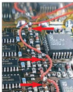
Bild 2: Senkrecht eingelötete SMD-Dioden im Multischalter; der Verbindungsdraht ist isoliert aus dem Gehäuse zu führen.
