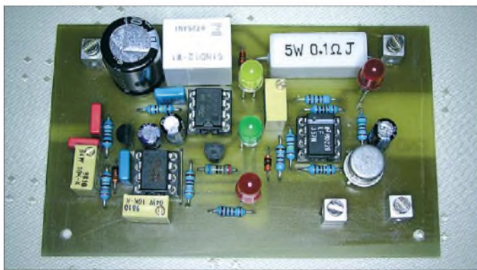
Bild 1: Ansicht der bestückten Platine der Ladungsüberwachung; die Leitungen vom Bordnetz und zum Zweitakkumulator werden nach dem Einbau in ein isolierendes Gehäuse an den stabilen Einzelklemmen befestigt.
