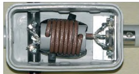
Bild 3: Die neue Speisedrossel weist eine Eigenresonanz von 145 MHz auf.
