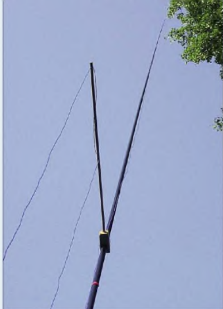
Bild 54: Querträger aus Rundholz und einem passend gebohrten Hartholzstück Fotos: DC1DV
