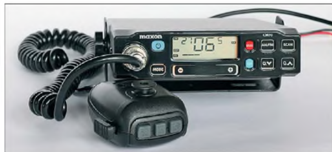
Bild 1: Das Maxon CM70 lässt sich über Sensortasten direkt am Gerät oder per Handmikrofon steuern.
