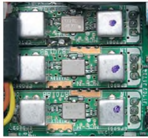
Bild 5: Ein Kernstück der verbesserten Eigenschaften des IC-7000 sind die drei auswählbaren Roofing-Filter.
