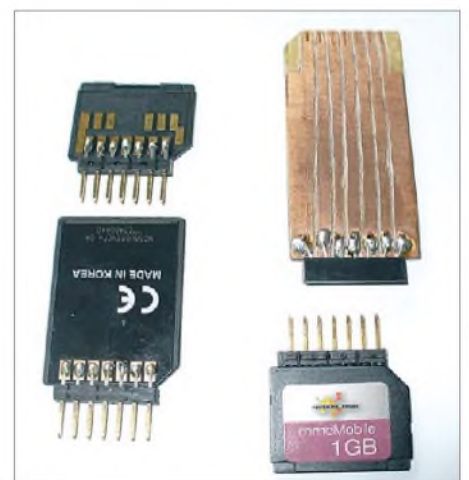
Bild 5: Verwendbare Multimediakarten mit angelöteten Stiftleisten und selbst hergestelltem Adapter
