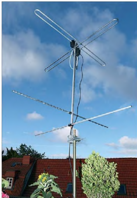
Bild 1: Eine Antenne – hier für NOAA-Satelliten –, ein Empfänger und Zorns Lemma verwandeln den Computer zur Wetterzentrale.
