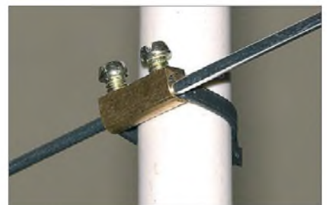
Bild 11: Detailaufnahme der Elementbefestigung für 2,4-mm-Stäbe mit Lüsterklemme und Schlauchbinder
