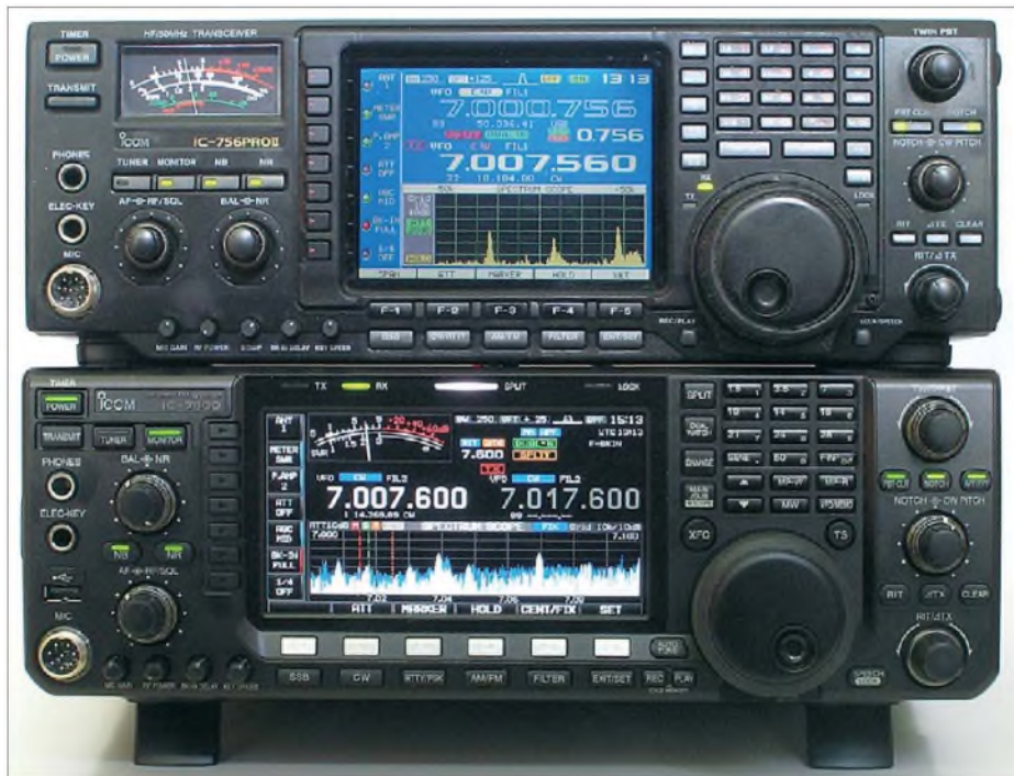
Bild 1: Vergleich von IC-7600 (unten) mit einem IC-756-PROII als Vertreter der 756er-Reihe, wobei sich PROII und PROIII äußerlich fast nicht unterscheiden. Fotos: DJ1TO
