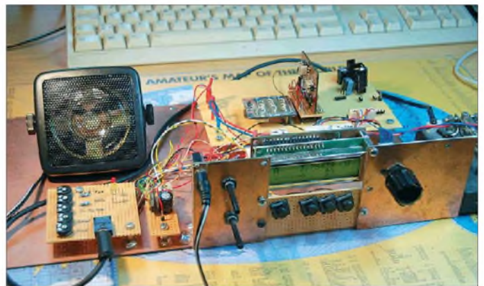
Bild 2: Testaufbau der Transceiver-Steuerung: Im Vordergrund ist das LC-Display erkennbar, unmittelbar dahinter befinden sich die Steuerbaugruppe und auf der Universalplatine senkrecht stehend die DDS-Baugruppe.
