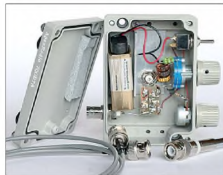
Die Stromversorgung der 700DTA übernimmt eine 9-V-Blockbatterie. Fotos: DL1ABJ
