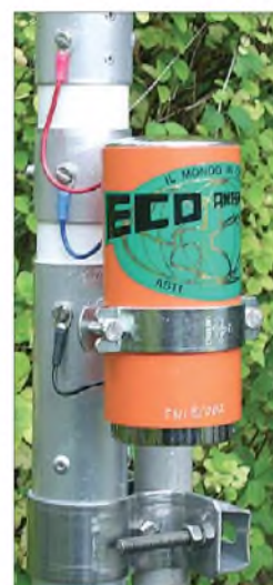
Bild 5: Die Antenne wird über den Anpassübertrager gespeist, aus dem drei Anschlüsse für den Mittenstrahler selbst, den gemeinsamen Befestigungsring der Seitenstrahler und den Masseanschluss herausgeführt sind. Der Strahler hat über diesen Anschluss eine galvanische Masseverbindung. Fotos: DJ9DV
