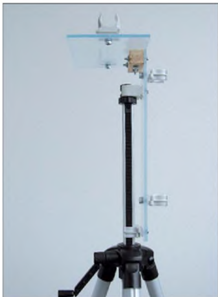
Befestigung der Antennenhalterung am Fotostativ
