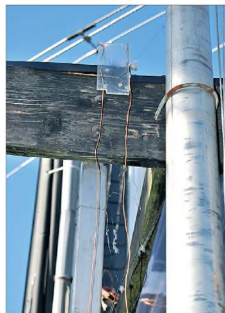
Bild 2: Eine Zweidrahtleitung mit Z-Match erlaubt im Idealfall die Anpassung in allen Bändern. Fotos: DL8OL
