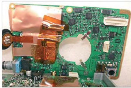
Bild 17: Quarze und Speicherchips auf der Tasaturplatte; rechts unten das Sensormodul
