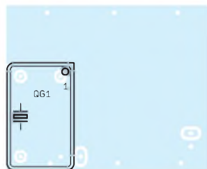
Bild 11: Platinunterseite mit dem 80-MHz-Quarz-oszillator
