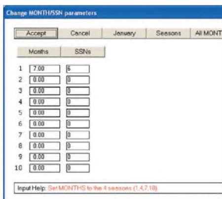
Bild 4: Hier verlangt VOACAP die Daten für den Monat und die Sonnenfleckenzahl (SSN). Eine Online-Hilfe gibt jeweils Hinweise auf die erwartete Eingabe.
