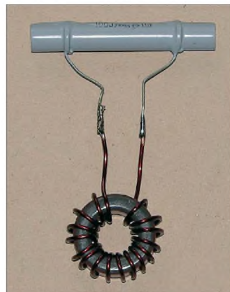
Bild 5: Komplett aufgebaute Sperrkreise für eine Resonanzfrequenz von 10,1 MHz mit 17 Windungen auf einen Ringkern T94-2 (Induktivität 2,45 \mu\text{H} ) und einem Parallelkondensator (Kapazität 100 pF)
