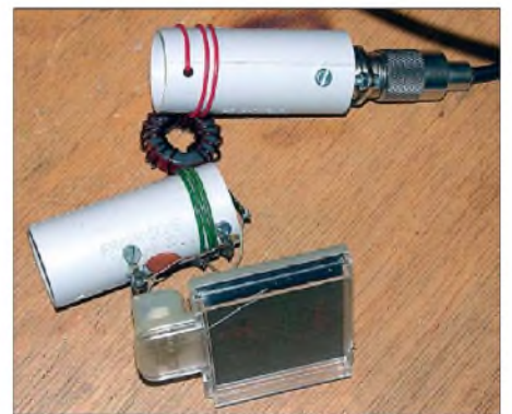
Bild 2: Die Messanordnung nach DK7ZB ist auch zum Abgleich von Ringkernspulen geeignet. Reihenfolge von oben nach unten: Einkoppelspule, Ringkern, Auskoppelspule mit HF-Messdetektor. Fotos: DK7ZB
