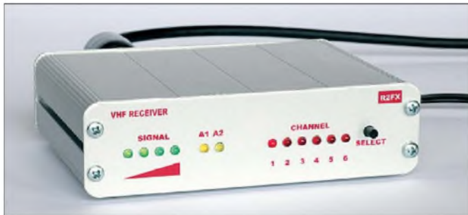
Bild 1: Ein Spezialist für NOAA-Empfang: der VHF-Empfänger R2FX von DF2FQ
