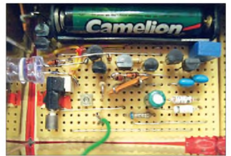
Bild 3: Das Nachweisgerät wurde auf einer Universalplatine aufgebaut.
