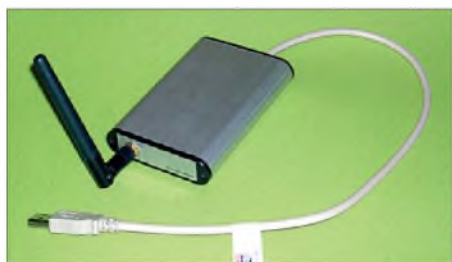
Bild 1: Das USB-Interface ist in einem Aluminiumgehäuse untergebracht.
