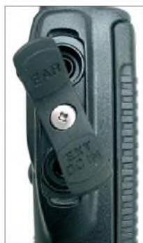
Bild 3: Die Kopfhörer- und Stromversorgungsbuchse werden wasserdicht abgedeckt.
