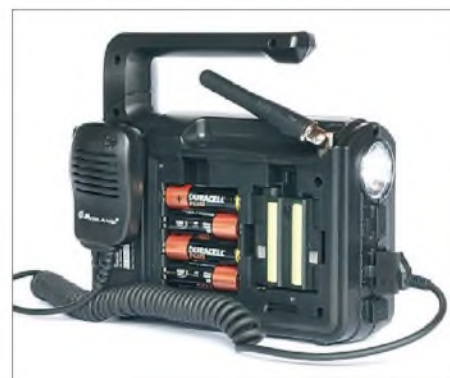
Seitlich liegen eine LED-Lampe sowie Buchsen für ein externes Lautsprecher-Mikrofon. Das rückseitige Batteriefach nimmt gleichzeitig den mitgelieferten Akkumulator und Mignon-Zellen auf.
