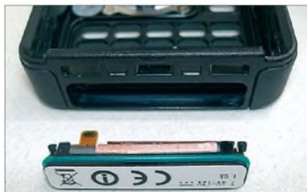
Bild 18: Die Kontaktfahne gehört zur Mittelwellenantenne, die außerhalb des Metallrahmens auf der Geräteunterseite versteckt ist.
