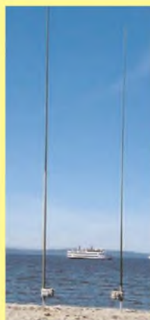
„BigIR“ (links) und „SmallIR“ heißen die Verticals von SteppIR, die Große für 40 - 10, die Kleine 20 - 10m.
