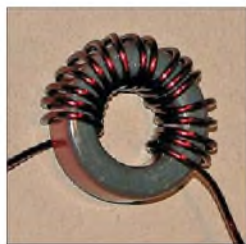
Bild 4: Bei der gedrängten Bewicklung desselben Ringkernes wie in Bild 3 stehen nun 2,8 \mu\text{H} zur Verfügung.
