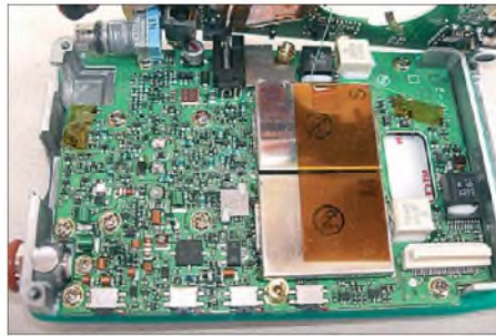
Bild 16: Blick auf den HF-Teil mit der Sendestufe links unten
