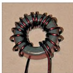
Bild 3: Die Verteilung von 16,5 Windungen auf fast dem gesamten Kernumfang des T94-2 führt zu einer Induktivität von 2,45 \mu\text{H} .
