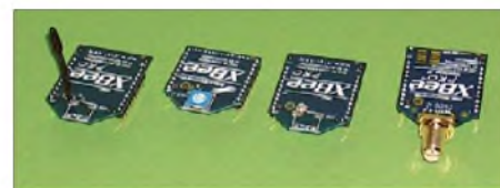
Bild 3: XBee-Module gibt es mit verschiedenen Antennen. Fotos: Sander
