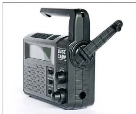
Der integrierte Kurbelgenerator lädt nicht nur den eigenen Akkumulator, sondern per USB-Buchse auch die von MP3-Playern oder Mobiltelefonen.
