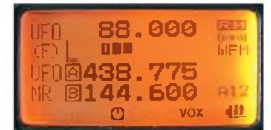
Bild 20: Drei Frequenzen werden simultan überwacht.
