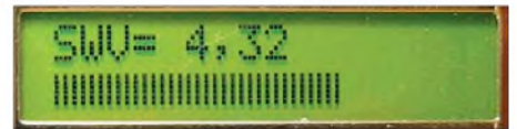
Bild 22: Die SWV-Anzeige liefert sowohl einen Zahlenwert als auch einen Balken für den schnellen Überblick.
