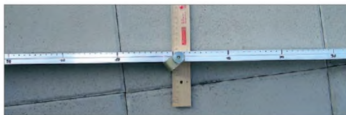
Bild 5: Auf den mit einem Filzschreiber eingezeichneten Durchmesser ist die Folie als Reflektor zu kleben.
