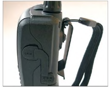
Bild 12: Der Gürtelclip aus Metall sitzt sehr straff, die Handschleife wird an ihm eingefädelt. Fotos: DG1NEJ
