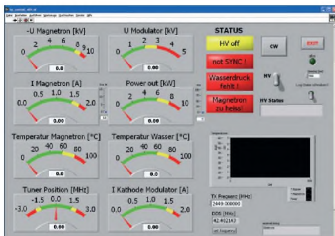
Bild 10: Bedienoberfläche der grafischen Magnetron-Kontrollsoftware; es werden Anodenspannung, Anodenstrom, Anodenspannung Modulator, Anodenstrom Modulator, Wassertemperatur, Magnetrontemperatur, Servoposition und Ausgangsleistung überwacht.
