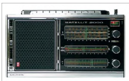
Bild 7: Im 70er-Jahre-Look and -Feel; der 2000er mit neuer jetzt direkt geschalteter Trommeltuner-Generation
