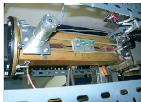
Bild 6: Ansicht des Gleitermechanismus; links der kleine Gleichstrommotor, rechts das Wendelpotenzimeter
