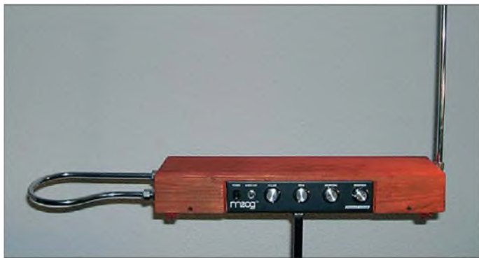
Bild 1: Etherwave-Theremin mit zwei Antennen, gebaut aus Robert Moogs Theremin-Bausatz Quelle: [1]
