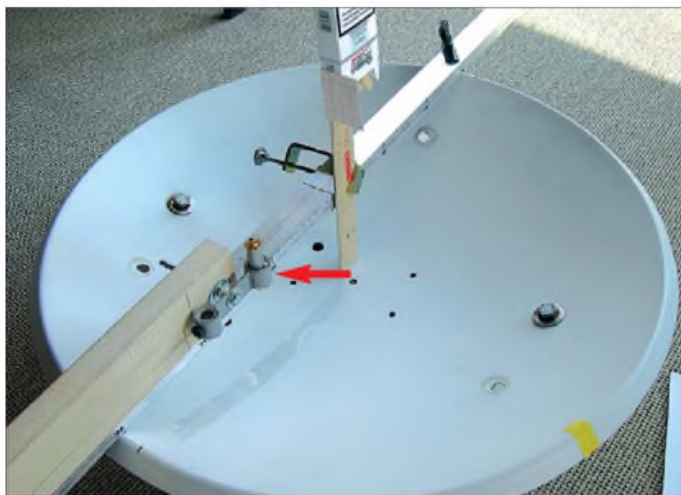
Bild 1: Messanordnung zur Bestimmung des Brennpunkts eines Parabolspiegels; Herzstück ist ein Laserpointer, der den einfallenden Strahl simuliert.
