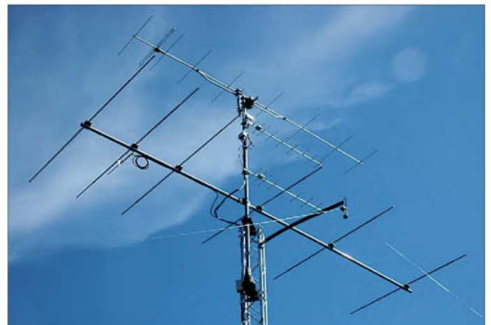
Auf 2 m arbeitet Christoph, DF9CY, mit einer Neunelement-Yagi nach DK7ZB, auf 70 cm mit 2 x Neunelement, ebenfalls nach DK7ZB, und auf 6 m mit der erwähnten Sechselement-XY-Yagi-Antenne.
