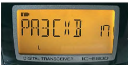
Bild 2: Das gut beleuchtete Display zeigt nur mit einer großen Segmentanzeige alphanumerisch an.
