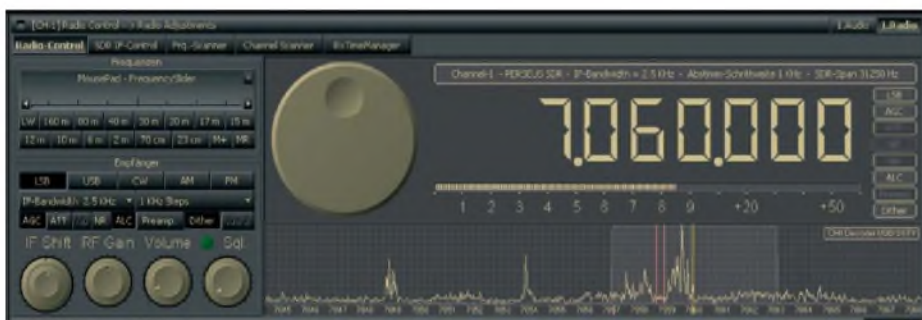
Bild 1: Beim Betrieb mit einem SDR zeigt die Bedienoberfläche (hier ein Ausschnitt) nun unter der Frequenz ein 24 kHz breites Spektrum mit den darin enthaltenen Signalen.
