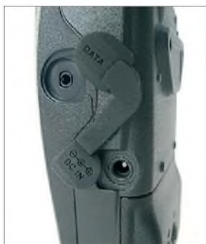
Bild 6: Auf der rechten Seite gibt es nun über der Stromversorgungsbuchse wieder eine normale 2,5-mm-Buchse als Datenanschluss.
