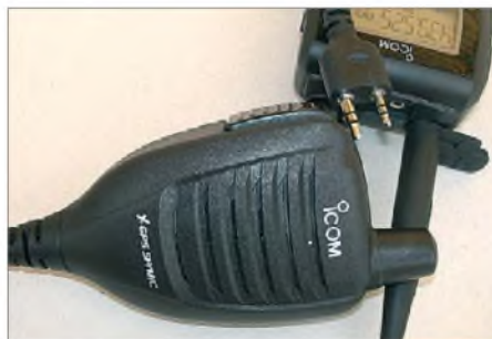
Bild 11: Das optionale GPS-Mikrofon HM-189GPS ermöglicht die automatische Positionsdatenübertragung im D-STAR-Netz.
