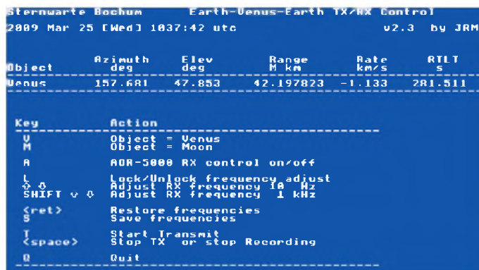
Bild 11: Screenshot der Software der AOR5000-Empfängersteuerung; wenn ein T gedrückt wird, dann tastet eine Softwaresequenz den Sender für die Zeitdauer der RTLT. Danach wird die Aufzeichnung mit der gleichen Zeitdauer gestartet; die Betriebszustände werden in Rot oder Grün angezeigt.
