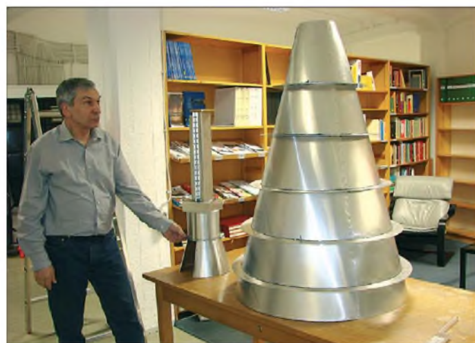
Bild 4: Freddy de Guchteneire, ON6UG, und das Horn; es besteht aus drei durch Blindnieten miteinander verbundenen 0,5 mm dicken Aluminiumblechen. Diese werden am Adapter mit einer großen Schlauchschelle gehalten, sodass ein perfekter Kontakt gewährleistet ist. Einige über das Horn geschobene und festgeklebte Ringe aus 2-mm-Aluminium halten das Horn in runder Form.
