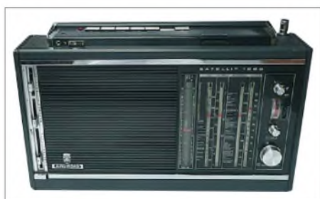
Bild 5: Neue Optik, 17 extrem gespreizte KW-Bänder, ansonsten folgte der Satellit 1000 der technischen Linie seiner Vorgänger.
