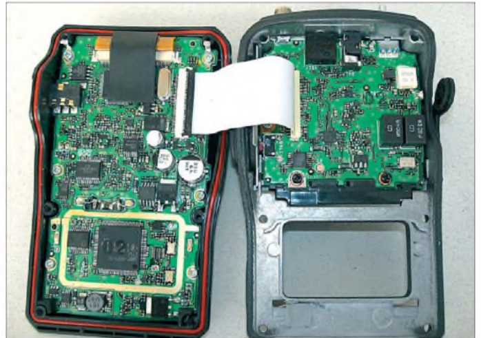
Bild 10: Der Blick ins Innere zeigt rechts die zwei ZF-Filter für NFM und NFM schmal.
