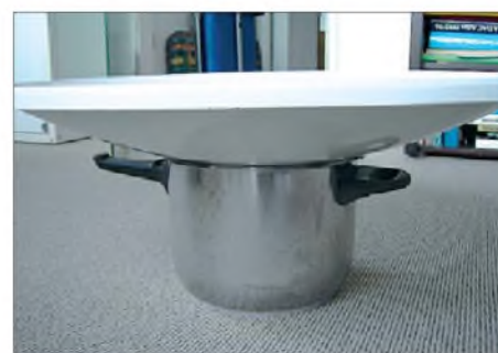
Bild 8: Für eine gute Standsicherheit des Parabolspiegels während der Messungen sorgt der genügend große Topf mit ein paar auf seinen Rand gelegten Gummistücken.
