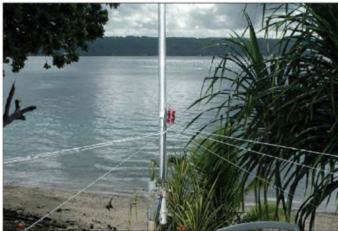
Unsere Vertikal für 80 m, 40 m, 20 m, 15 m und 10 m konnten wir auf der Insel Aore (Vanuatu) in unmittelbarer Nähe des Pazifik aufbauen. Die Befestigung am Geländer der Veranda war problemlos möglich.
