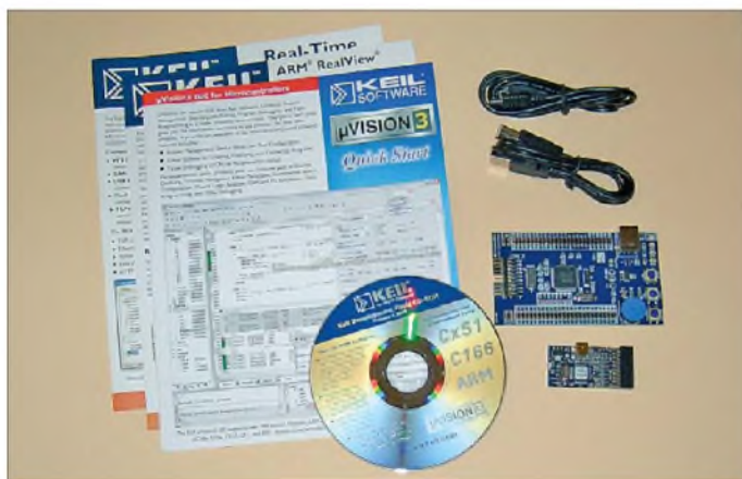
Bild 1: Mit dem Starterkit werden Evaluation- board mit TMPM330, JTAG-Adapter und Software geliefert.
