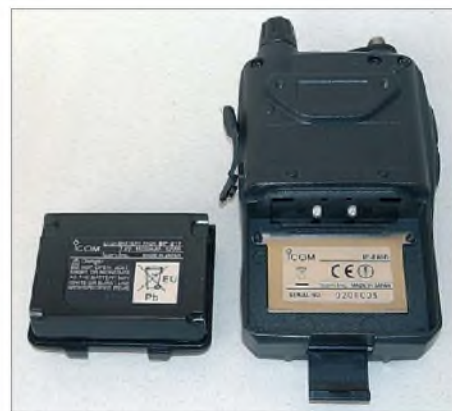
Bild 3: Der Li-Ion-Akkumulator hat die beachtliche Kapazität von 1,5 Ah bei 7,4 V.
