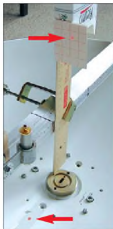
Bild 10: Während der Messung sind deutlich die Spiegelung des Laserstrahls an der Folie und die Abbildung des Brennpunkts auf dem Millimeterpapier zu erkennen. Fotos: DH8AG
