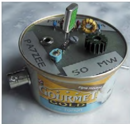
Der von Geert, PA7ZEE, für 30 m konzipierte 50-mW-Sender in der Tunfischdose nach W1FB.
