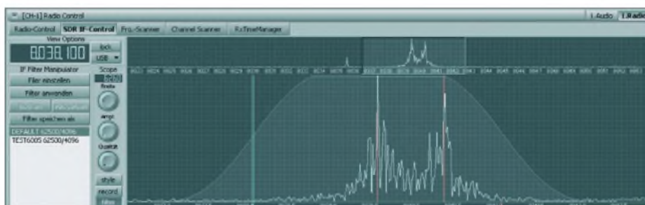
Bild 2: Die genauere Analyse eines empfangenen Signals ermöglicht das Programm unter SDR IF-Control. Hier lässt sich auch das ZF-Filter anpassen, um etwa Störungen aus dem Nutzsignal zu entfernen.
