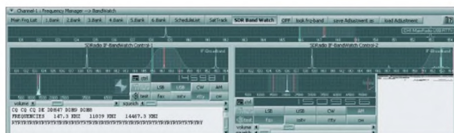
Bild 3: RC6 demoduliert (und decodiert) mit der Funktion SDR Band Watch gleichzeitig bis zu vier Signale auf verschiedenen Frequenzen im Empfangsfenster, hier den Deutschen Wetterdienst in RTTY auf 147,3 kHz und Deutschlandfunk in AM auf 153 kHz.
