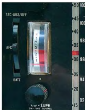
Bild 2: Die herausragenden UKW-Empfangeigenschaften wurden von einer schaltbaren AFC unterstützt.
