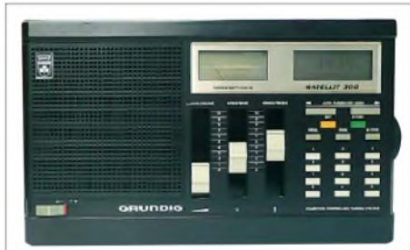
Bild 17: Der Satellit 300 ist ein relativ kompakter Einfachsuper mit erstmals voll digitaler Abstimmung.
