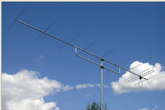
Die YA014410 besitzt eine zusätzliche Abstimmung des gespeisten Dipols.
