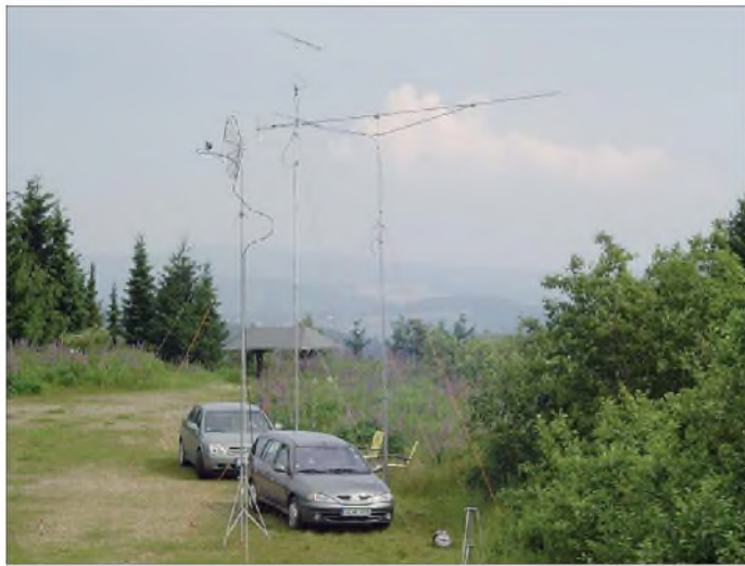
DL0VLA/p war auf 2 m mit etwa 100 W Ausgangsleistung an einer 17-Element-Langyagi QRV, alles aus 12-V-Batterien betrieben.
