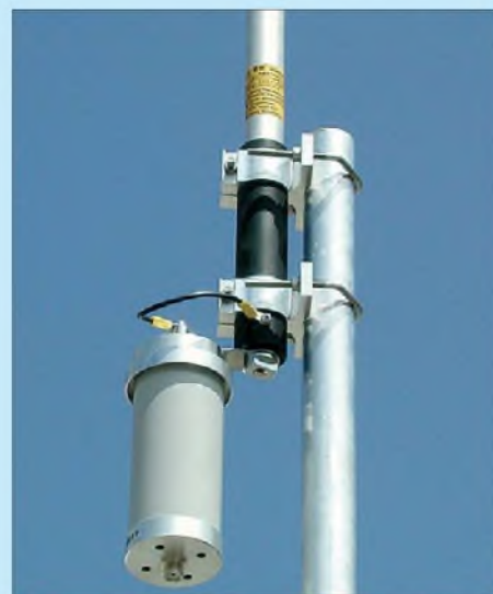
Bild 60: Einspeisung der Breitband-Groundplane-Antenne BB-7V; unten ist der Balun (MTFT) zu erkennen. Fotos: WiMo
