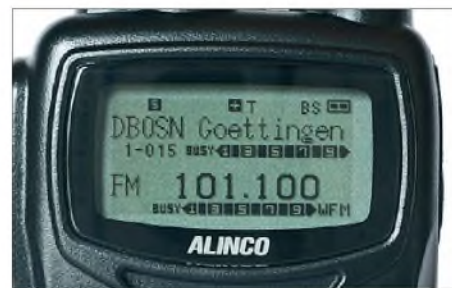
Bild 7: Zur besseren Übersicht lassen sich Speicherfrequenzen alphanumerisch benennen.
