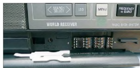
Bild 25: Originell – Senderspeicherung auf austauschbaren und im Gerät kopierbaren EEPROMs beim Satellit 700
