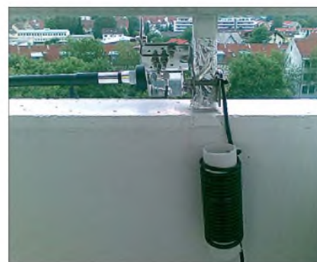
Bild 4: Mantelwellensperre nahe am Fußpunkt aus 20 Windungen Koaxialkabel Fotos: DL2WB
