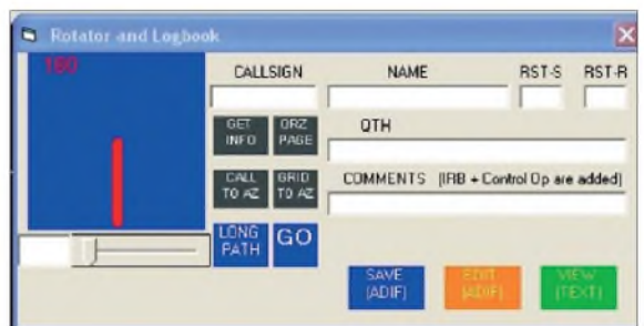
Bild 4: Bedienoberfläche für die Rotorsteuerung und das elektronische Logbuch
