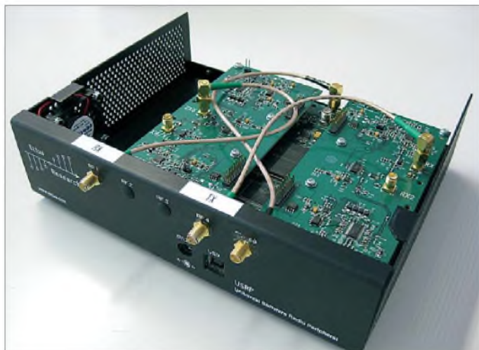
Bild 4: Das Universal Software Radio Peripheral (USRP) mit Umsetzkarten für den 1800-MHz- Bereich
