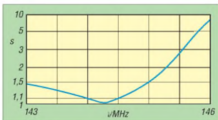
Bild 3: SWV-Verlauf der Zwölfelement-DK7ZB-Yagi für das 2-m-Band
