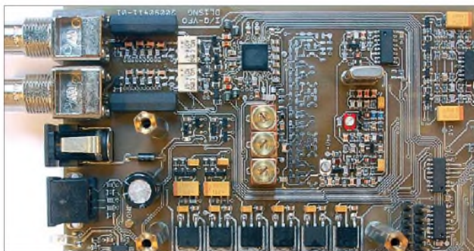
Bild 9: Die Bauelemente der Stromversorgung und des HF-Teils auf der Grundplatte
