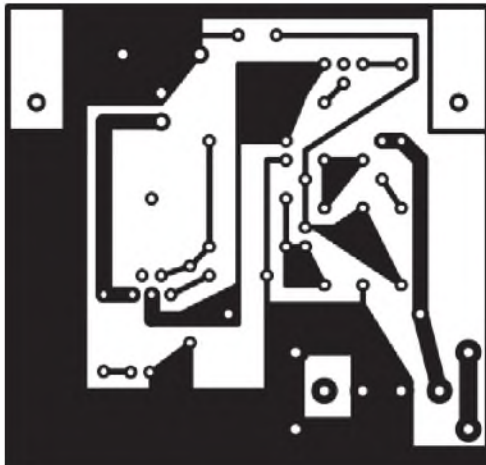
Bild 6: Leiterplatte für die Schutzschaltung 1; Abmessungen 64 mm × 61 mm, M 1:1
