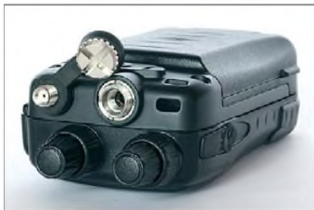
Bild 5: Die vierpolige Spezialbuchse auf der Oberseite dient zum Anschluss externer Mikrofone, Kopfhörer und Hörsprechgarnituren; auch die Datenkommunikation mit einem Computer läuft darüber.
