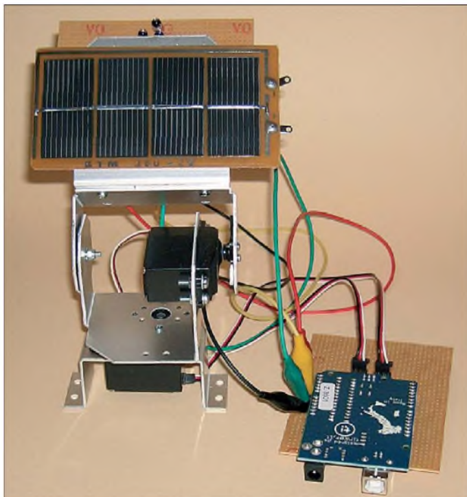
Bild 1: Nur bei der optimalen Positionierung einer Solarzelle lässt sich ihr die maximale Leistung entnehmen. Soll dies über einen längeren Zeitraum erfolgen, ist sie daher der Sonne als Lichtquelle nachzuführen. Im gezeigten Beispiel übernehmen dies zwei Servomotoren, deren Ansteuerung ein Arduino-Board übernimmt.
