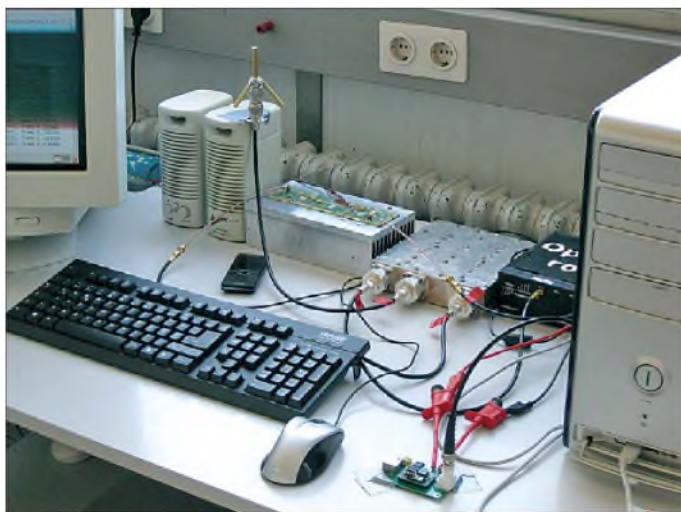
Bild 6: Blick über den kompletten Testaufbau im Labor; rechts sieht man den PC auf dem die OpenBTS-Applikation sowie der Asterisk-Server laufen. Gleich links daneben befindet sich das über USB angeschlossene USRP. In der Mitte steht der Duplexer, gefolgt von dem Verstärker. Den Abschluss an der linken Seite bildet die Antenne.
