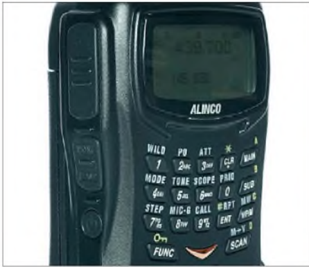
Bild 8: Die Bedienelemente des DJ-G7E sind durchgehend robust und lassen lange Lebensdauer erwarten. Der Ein-/Aus-Schalter liegt etwas versteckt auf der linken Gehäuseseite.
