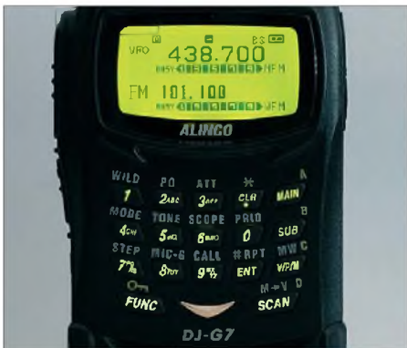
Bild 9: Dank des beleuchteten Tastenfeldes bleibt der Alinco auch bei Dunkelheit bedienbar. Fotos: DL1ABJ
