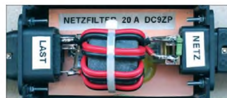
Bild 6: Robustes Eigenbaunetzfilter mit zwei Ringkernen für eine Strombelastbarkeit von I_N = 20\text{ A} Fotos: Werkfotos (2), DC9ZP (3)
