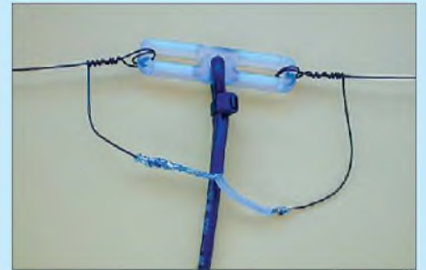
Bild 64: Dieser Mini-Mehrzweckisolator aus Polycarbonat (6 g, Bezug: [35]) ist vielseitig einsetzbar; hier dient er als Mittenisolator einer leichten Drahtantenne
