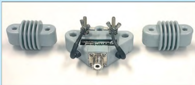
Bild 63: Dieser wuchtige Mittenisolator von Alpha Delta verträgt bis zu 4 kW PEP; er enthält zusätzlich eine Blitzschutzpatrone und besitzt ein Befestigungsloch zur Aufhängung; rechts und links zugehörige Endisolatoren. Bezug: [59]
