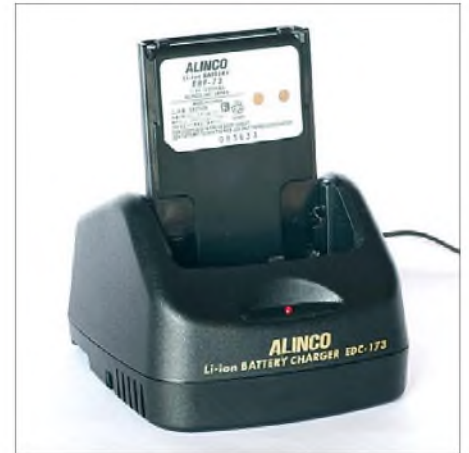
Bild 4: Zum Lieferumfang gehört dieses Standladegerät, das einen leeren Akkumulator in 3 h wieder einsatzbereit macht.
