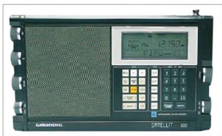
Bild 23: Als erste echte Antwort auf den ICF-2001D hatte der Satellit 500 unter anderem einen Synchrondetektor, einen PLL-Synthesizer und eine ROM-Sendertabelle.
