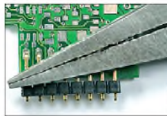
Bild 10: Mit einer Zange und sanfter Ge- walt lässt sich der Isolierkörper von den Stiften schieben.
