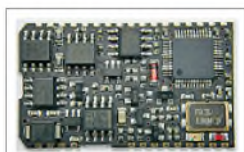
Bild 2: Herz des OBD2-Interfaces ist das Modul DXM von Diamex.
