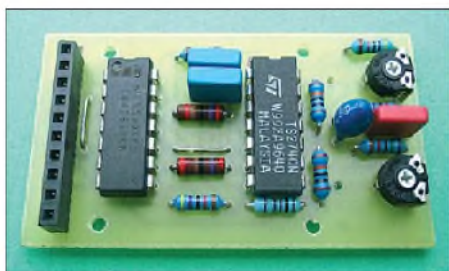
Bild 4: Fertig bestückte Platine; es werden ausschließlich bedrahtete Bauelemente verwendet.
