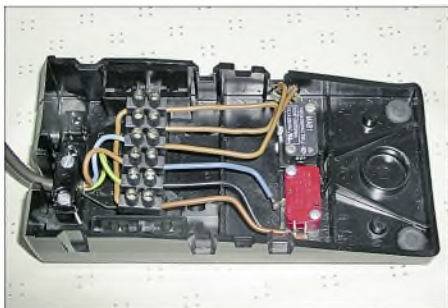
Bild 7: Damit die Hände zum Führen des aufzuwickelnden Drahtes frei sind, sollte ein entsprechend verdrahteter Fußschalter zum Einsatz kommen. Fotos: OE1MSA
