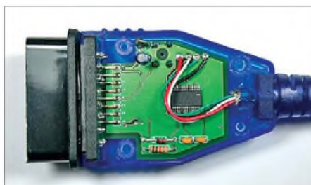
Bild 14: Oberseite des geöffneten OBD2-Steckers; der FT232RL ist in der USB-Variante bereits bestückt. Fotos: Stange, Reuss
