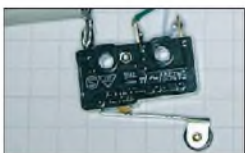
Bild 2: Ansicht des verdrahteten Mikroschalters für den Impulsgeber
