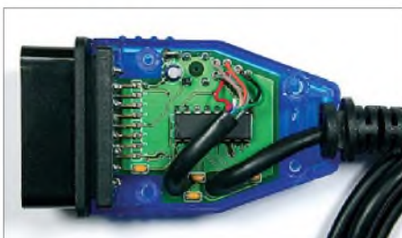
Bild 12: Oberseite des geöffneten OBD2-Steckers; der MAX3232 ist mit gekürzten Anschlüssen einzulöten.
