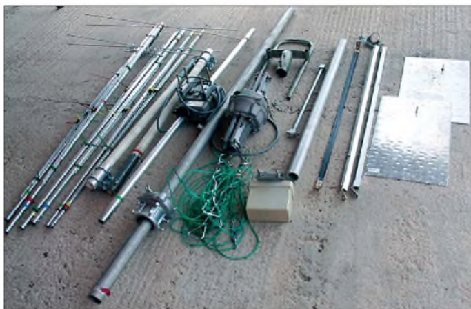
Bild 1: Die Anlage im „Transportmodus“ von links nach rechts: zusammengelegte Antennen, Glasfaserrohrstummel, mittleres Querrohr mit Vertikalrotor, oberes senkrechtes Tragrohr mit Oberlager, Horizontalrotor, Kfz-Fuß, Abspannung mit Erdankern, Anpasstopf, Vorverstärker, unteres Tragrohr, Tripodelemente, Fußbleche
