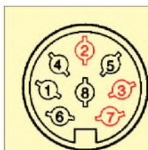
Bild 2: Zählweise der Anschlüsse an der 8-poligen ACC-Buchse des IC-910H (auf die Buchse gesehen)
