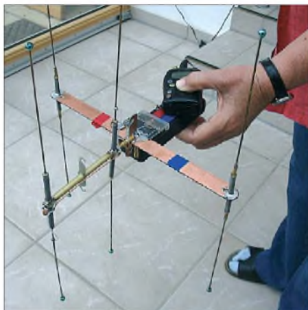
Bild 1: Vollständiger Aufbau des Phasenpeilers einschließlich Antennen
