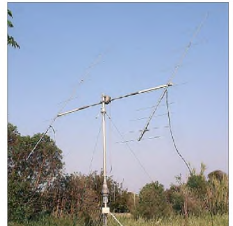
Bild 5: Die Anlage im „Betriebsmodus“ und in voller Schönheit; die Gesamthöhe über Grund beträgt 3 m. Mehr hilft bei EME-Betrieb ohnehin nicht und alles ist noch recht unauffällig und leicht. Gesamtmasse: 12 kg; Aufbauzeit mit etwas Übung: 1 h
