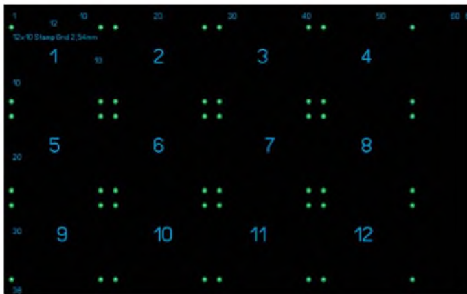
Bild 1: Prinzipielle Einteilung einer Europakarte in zwölf Funktionseinheiten; Lötäugen symbolisieren hier die Eckpunkte.
