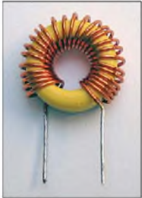
Bild 11: Bewicklung der Ringkerne für die Spulen L1 bis L4 des Preselektors am Beispiel von L3
