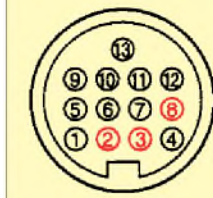
Bild 3: Zählweise der Anschlüsse an der 13-poligen ACC-Buchse des IC-706 (auf die Buchse gesehen)
