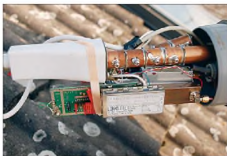
Der Datenlink zum Klubheim der Weinheimer Funkamateure: DB0WHM, 614 kBit/s auf 10 GHz
