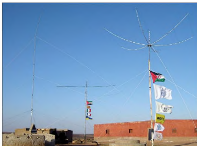
Ein Teil der diversen Antennen der S04R-Unternehmung: rechts der Fünfband-Hex-Beam, daneben der Dipol für 80 m (CW), dann der Fünfband-Spiderbeam und ganz links die Vertikal für das 40-m-Band
