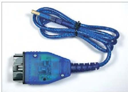
Bild 1: Ansicht des aufgebauten DXM-Interfaces in der USB-Variante
