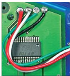
Bild 7: Anschluss des Kabels der USB- Schnittstelle; +USB → rot, D+ → weiß, D- → grün, -USB → schwarz
