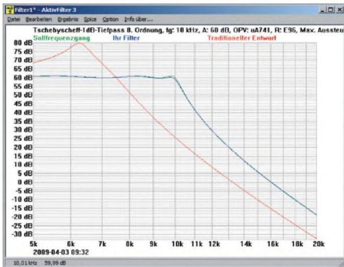
Bild 6: Frequenzgang mit (blau) und ohne (rot) Berücksichtigung der Eigenschaften eines realen Operationsverstärkers
