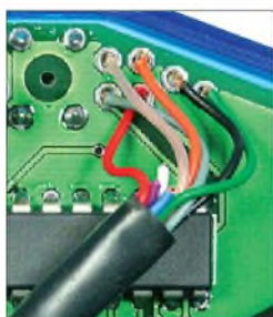
Bild 8: Anschluss des Kabels der RS232-Schnitt- stelle; TP1 → schwarz, TP2 → grau, TP3 → rot, TP4 → orange, TP5 → braun, TP6 → grün
