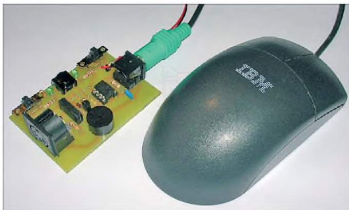
Bild 1: Ansicht des PS/2-Maus-Keyers und der verwendeten Zweitastenmaus
