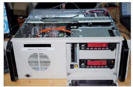
D-STAR-Repeater mittels handelsüblicher Amateurfunkgeräte sowie einem modifizierten Node-Adapter Foto: DH5FFL
