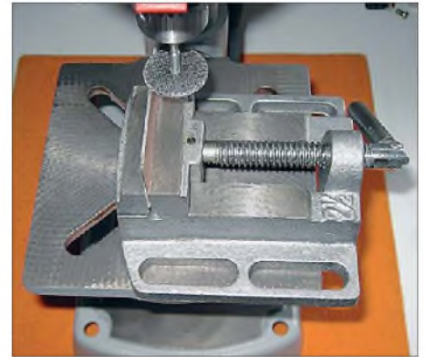
Bild 3: Als Alternative zur Verwendung eines Zweiachsen-Maschinenschraubstocks eignet sich ein gewöhnliches Exemplar, wobei dann der gesamte Ständer mit der eingespannten Platine an der Trennscheibe entlang über den Bohrtisch zu schieben ist.
