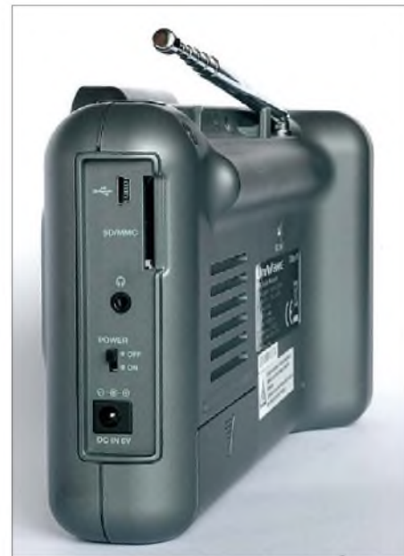
Bild 2: Seitliches Anschlussfeld mit Steckplatz für Speicherkarten
