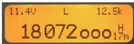
Bild 25: Rundung der eingestellten Frequenz auf kHz
