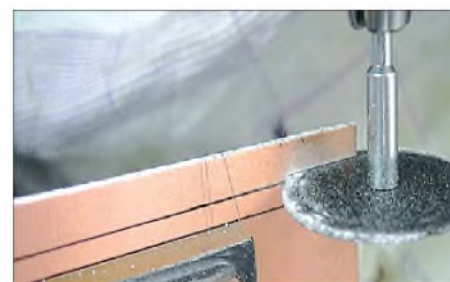
Bild 8: Die Platine ist an der unteren Hilfslinie zwischen die Klemmbacken festzuschrauben. Anschließend an der eigentlichen Trennlinie vor dem Schneiden mit der stillstehenden Trennscheibe zur Probe entlang fahren und die Einspannung gegebenenfalls korrigieren. Fotos: DH8AG
