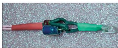
Bild 2: Bis auf die LED sind alle Bauteile noch einmal zusätzlich mit Schumpfschlauch zu überziehen. Foto: DG5MDB
