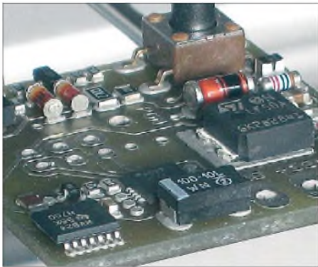
Bild 13: Platine in der Vorwärmphase; die Paste ist noch zäh.
