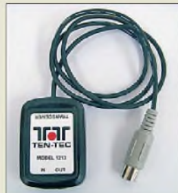
Das Model 1213 trennt Transceiver und PC wirkungsvoll.
