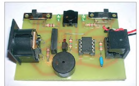
Bild 3: Vollständig bestückte Leiterplatte des PS/2-Maus-Keyers Fotos: DK8JH
