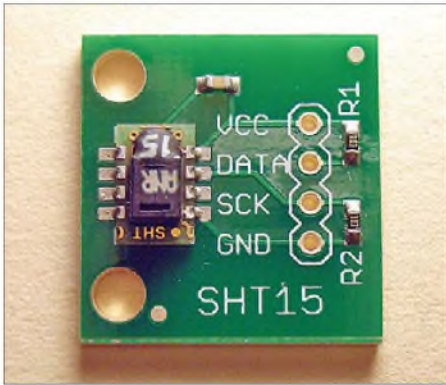
Bild 1: Auf der Platine von Sparkfun, siehe Text, ist der Sensor SHT15 in SMD-Technik bereits bestückt. Foto: Sander
