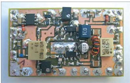
Bild 17: Labormuster des 1-W-Verstärkermoduls
