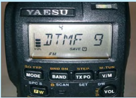
Bild 3: Manche Miniaturfunkgeräte, wie das VX-3R, bieten zwar keine direkten DTMF-Tasten, erlauben aber dennoch die Erzeugung der Töne.
