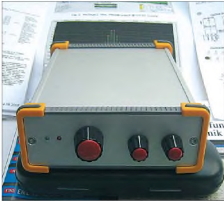
Bild 25: Labormuster des FA-SDR-TRX im Gehäuse Fotos und Screenshot: DL2EWN
