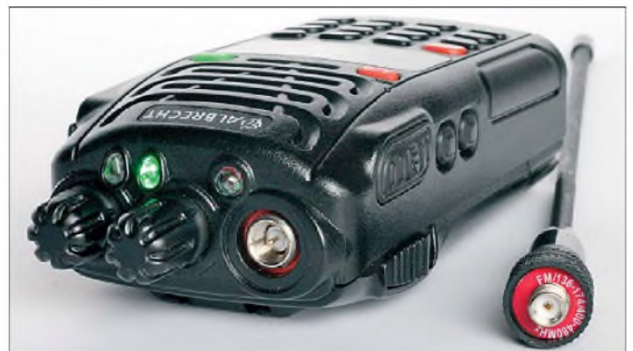
Bild 2: Die versenkte Reverse-SMA-Antennenbuchse verlangt einen speziellen Adapter, um das Gerät mit anderen Antennen zu verbinden.
