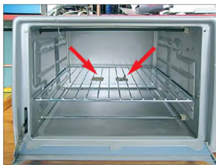
Bild 11: Der Ofen bietet auch Platz für größere Platinen. Hier waren es nur die Testplatine und eine Messplatine daneben.
