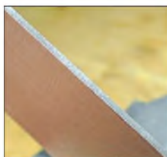
Bild 6: Zuschnitt einer 1,5 mm dicken Epoxid-Leiterplatte mit der Diamant-Trennscheibe aus Bild 4
