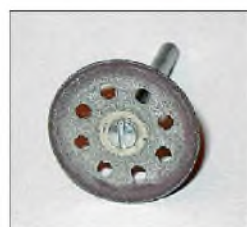
Bild 4: Diamant-Trennscheibe mit 22 mm Durchmesser und 0,6 mm Dicke nach einigen Einsätzen
