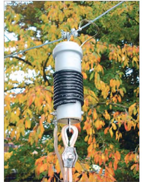
Bild 3: Ausführung des Sperrkreises aus Koaxialkabel
