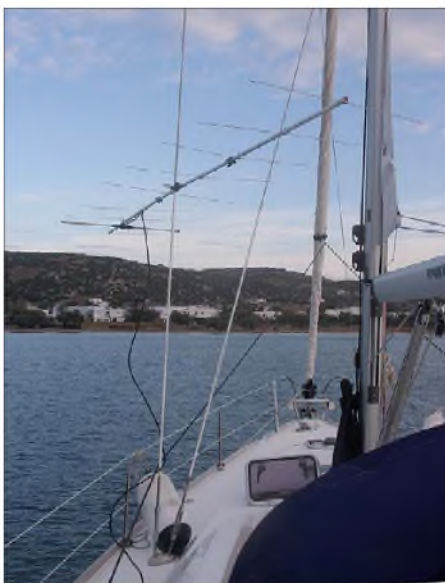
Die Neunelement-Tonna von DH7FB/mm musste je nach Ankerposition quer übers Boot strahlen.
