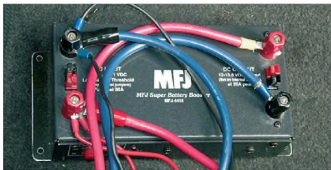
Bild 1: Bei der Verdrahtung ist auf ausreichende Leitungsquerschnitte zu achten.
