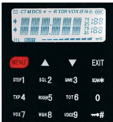
Bild 3: Auch bei Dunkelheit bedienbar: Display (hier alle Segmente aktiv) und Tastenfeld sind hell beleuchtbar. Fotos: DL1ABJ
