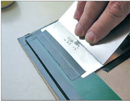
Bild 8: Die Lötpaste beim Rakeln in einem Zug in die Löcher der Schablone drücken.
