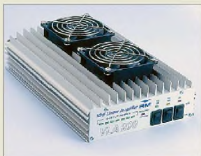
Profilkörper nebst Lüfter sorgen bei der VLA-200V für den kühlen Betrieb.
