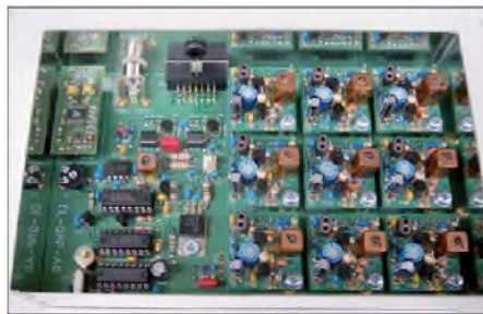
Der 9-Band-VCO (LO-Frequenzaufbereitung) des Langzeitprojekts Solf2009 kommt als kompakte Einheit daher. Foto: DK1HE
