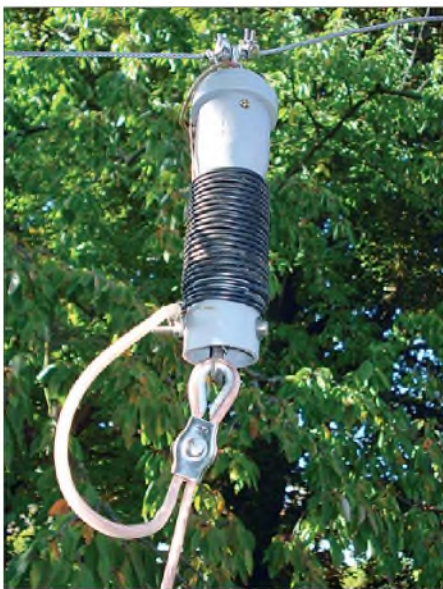
Bild 5: Sperrkreis in der Variante mit Kondensator und Spule
