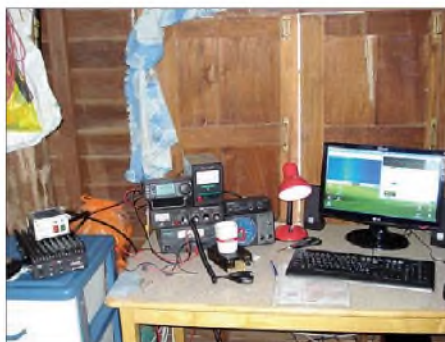
Karstens Shack; bei 35 °C Raumtemperatur waren die zusätzlichen Lüfter auf der kleinen Transistor-PA für dieselbe im wahrsten Sinne des Wortes lebensnotwendig. Fotos: DL2LAH
