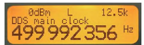
Bild 24: 500-MHz-Referenzoszillatorfrequenz bei aktiver Regelung mit externem Referenztakt
