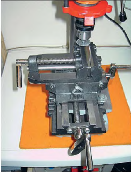
Bild 1: Durch den Vorschub mit einer Kurbelspindel wird der Platinenschnitt gefühlvoll gesteuert.
