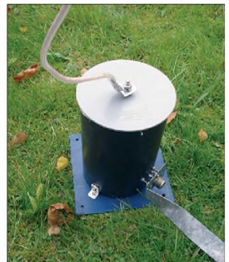
Bild 7: Das 110 mm dicke Kunststoffrohr gibt dem Speisepunkt Halt und kann ggf. eine Verlängerungsspule aufnehmen. Fotos: DK6ED
