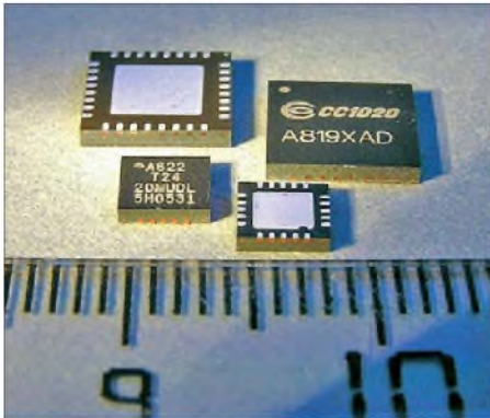
Bild 1: Bei den modernen ICs im QFN-Gehäuse sind die Lötflächen seitlich nicht mehr zugänglich.
