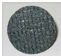
Bild 5: Unbenutzte glasfiberverstärkte Trennscheibe mit 32 mm Durchmesser und 1,2 mm Dicke
