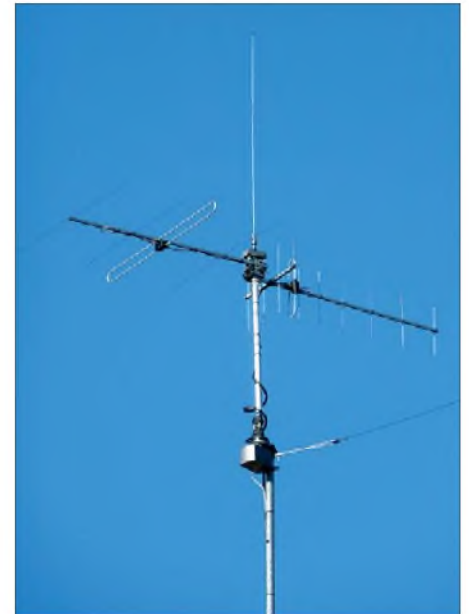
Bild 2: Aktiv-/Passiv-Vertikalstrahler mit Yagi-Antennen als Radials Foto: DJ8IL
