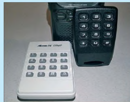
Bild 2: Vor das Mikrofon gehaltene einfache DTMF-Handsender ermöglichen die Bedienung des EchoLink-Systems.
