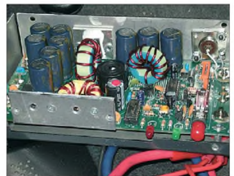
Bild 2: Blick in den geöffneten Gleichspannungswandler MFJ-4416B mit den Bauteilen zur Entstörung Fotos: OE3MZC
