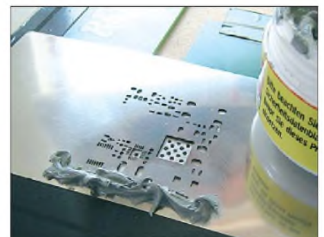
Bild 7: Auftragen der Lötpaste; größere Durchbrüche erfordern mehr Paste am Rand.
