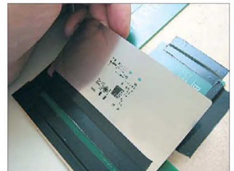
Bild 5: Anbringen der Lötpastenschablone mit Klebestreifen
