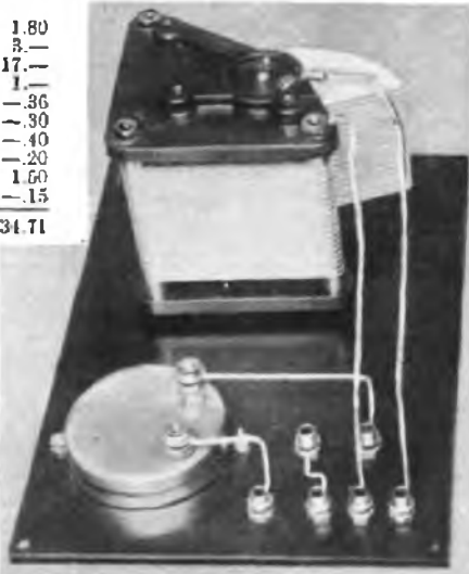
Abb. 7. Ein Blick unter den Deckel des Überlagerers (links) und des Wellenmessers (rechts oben).
