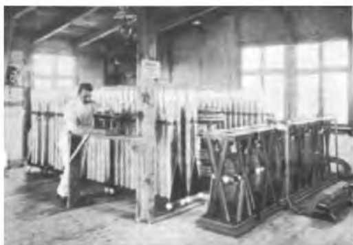
Großstation Nauen. Sender vom Jahre 1906 (360 Leydener Flaschen und Knallfunke.)
