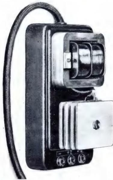
Abb. 3. Der Gleichrichter geöffnet: Oben der Transformator, unten die eigentlichen Gleichrichterzellen
