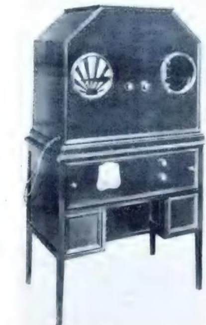
Der „Televisor“ von Baird. Der vorstehende Apparat ermöglicht das gleichzeitige Sehen und Hören. Im unteren Teile des Schrankes ist das Empfangsgerät nebst den dazu notwendigen Batterien untergebracht, während der obere Aufbau links auf dem Bilde den Lautsprecher und rechts die Öffnung, in der die Bilder zum Vorschein kommen, beherbergt. (Modell „B“ von Baird). Phot. Maros
