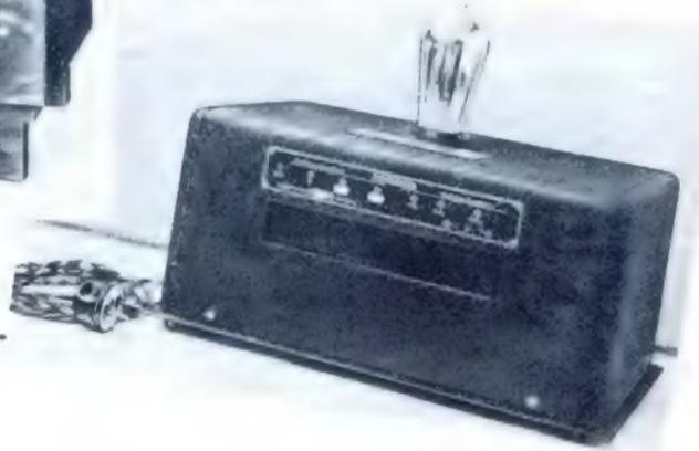
Oben: Der 1-Watt Kraftverstärker (Körting)
