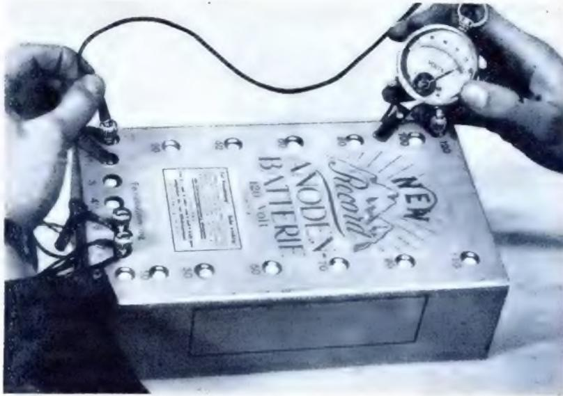
sonst geht die Batterie doppelt schnell zugrunde! — sind nicht unerschwinglich teuer. Ein Drehmagnetinstrument, das man mit seinem zweiten Meßbereich noch zur Messung des Heizakkus verwenden kann, kostet etwa M. 7.—, ein Drehspulinstrument, das noch besser ist, weil es die zu messende Batterie noch mehr schont und genau arbeitet, kostet etwa M. 17.—.
