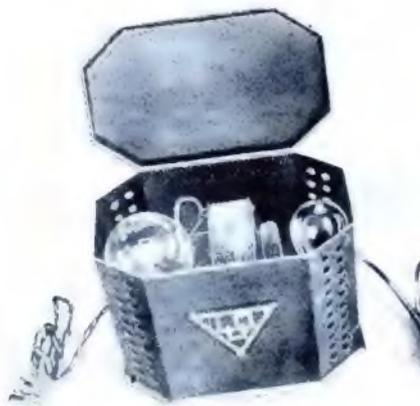
Innenansicht eines Ladegleichrichters für Anodenakkumulatoren. Rechts die Gleichrichterröhre, in der Mitte der Transformator, links die strombegrenzende Widerstandslampe.
