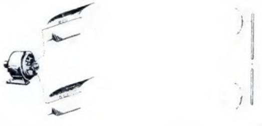
Mit zwei Hohlspiegeln werden die kurzen Wellen nach der Empfangstation gelenkt: sie dienen dabei gleichzeitig als elektrische Leitungen.
