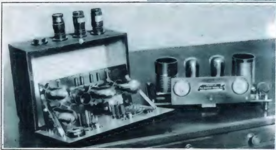
Ein Zweiwellensender, gebaut für die Panamerikanische Lufthansa.
