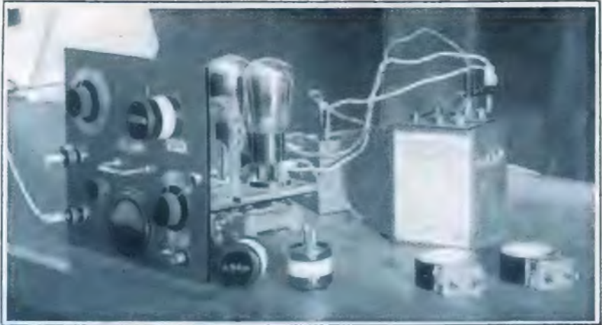
Der kleinste quarzgesteuerte Kurzwellensender im Heinrich Hertz-Institut. Phot. Berl. III. Ges.
