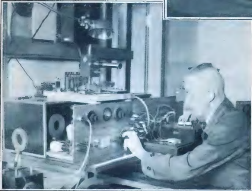
Hier werden atmosphärische Störungen mit dem Elektrometer quantitativ gemessen. Phot. Berl. III. Ges.
