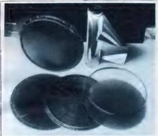
Abb. 28. Einzelteile des elektrostatischen Oscilloplan-Lautsprechers.
