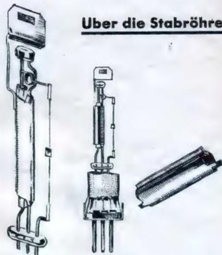
Abb. 1 und 2. Die Eingeweide eines Telefunkenstabes. Abb. 3. Das Anodenblech alleine. Wir sehen deutlich, wie es aus einem Stück gebogen und — im Bild auf der linken Seite — verschweißt ist.
