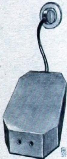
1. Wir verwenden eine käufliche Glätteinrichtung. Diese besitzt auf der einen Seite eine kurze Netzlitze mit Stecker. Der Stecker kommt in die Netzsteckdose. Auf der anderen Seite befinden sich zwei Buchsen, in die die Steckerstifte des Netzsteckers des Empfängers hineingehören. Die Geschichte sieht übrigens genau so aus, wie eine Hochfrequenzsperr.
