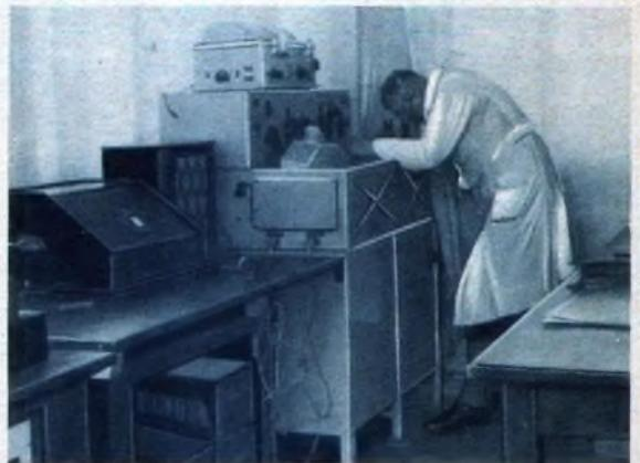
An diesem Feinmeßgerät liest man die eingestellte Welle mit dem Mikroskop ab. (Den Empfänger oben kennen die FUNKSCHAU-Lefer bereits.)
