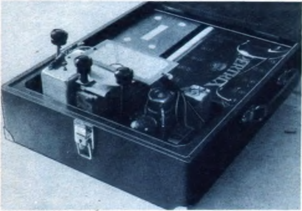
Eine der wichtigsten Neukonstruktionen dieses Jahres, der Kötting-Empfänger von Kötting-Radio. Um das Chassis zu zeigen, ist die Deckelplatte abgenommen. (Werkphoto)
