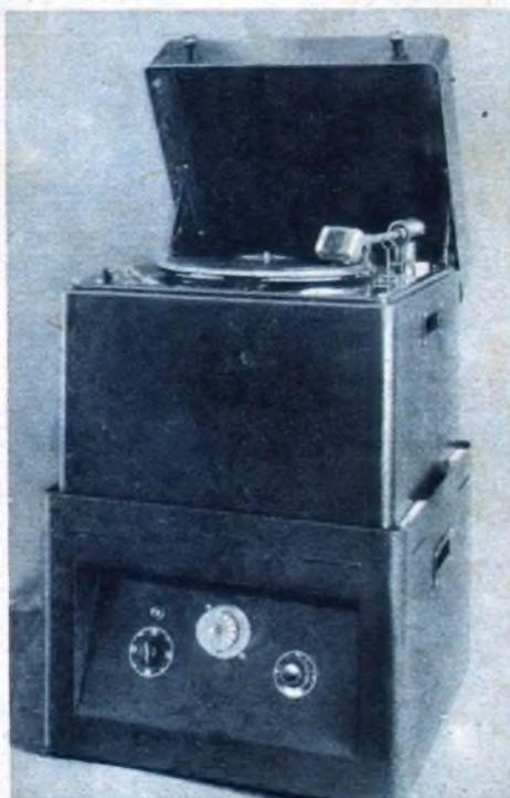
Eine Verstärkeranlage, gebaut für die besonderen Bedürfnisse von Rundfahrt-Autos und Reise-Omnibussen. Im unteren Teil des Kastens befindet sich der Umformer. Werkphoto Philips.
