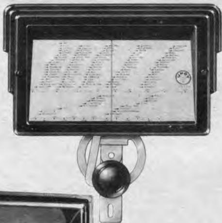
Abb. 5. Eine Skala mit Zahnrad- und Seilantrieb.
