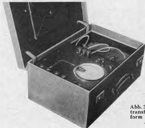
Abb. 3. Ein Gleichstrom-Transformator in Kofferform - 5000 Volt aus einer Anodenbatterie!
