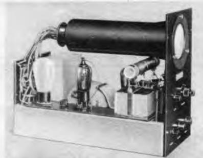
Die praktische Ausführung des tragbaren Oszillographen geöffnet. Werkaufn. Leybold u. v. Ardenne
