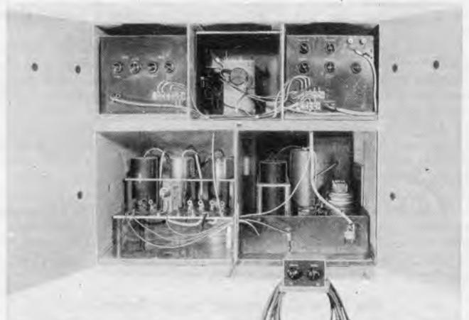
Ein Bild von rückwärts in den Großbild-Fernleheempfänger. In der Mitte oben die Fernlehröhre. Sämtliche Aufnahmen: Werkaufnahmen Telefunken.
