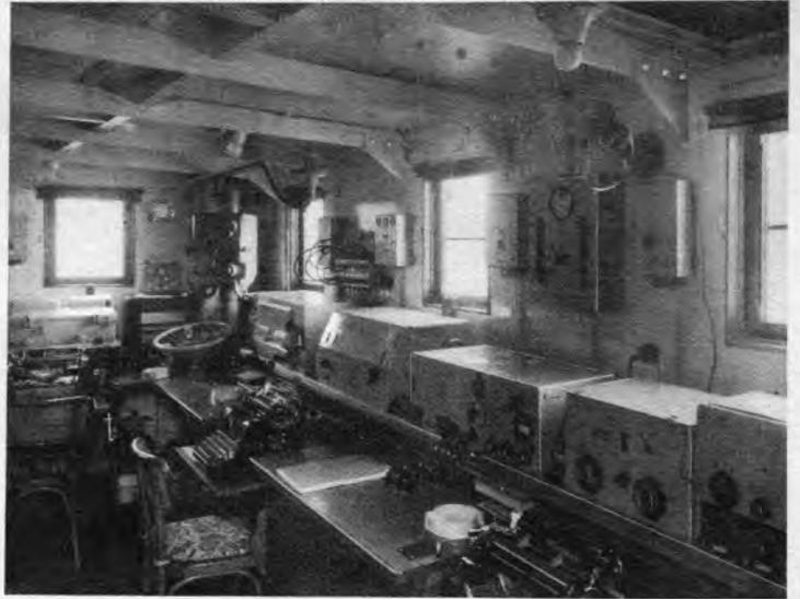
Die Funkkabine des neuen Flugzeugstützpunktes „Ostmark“ ist mit einer großen Zahl von Empfängern ausgerüstet. Sie enthält 2 Groß-Super, 1 Allwellen-Empfänger, 1 Mittel- und Langwellen-Empfänger, 1 Geradeaus-Empfänger und 1 Kurzwellen-Empfänger. In der Ecke sieht man das Handrad für den Antrieb des Peilrahmens und den Empfänger dazu.
