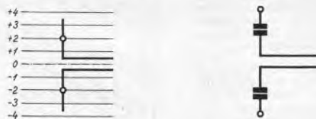
Abb. 2. Als ungefähres Maß für die wirkfame Antennenhöhe kann man die Entfernung der beiden Antennenmittelpunkte ansehen. Die wirkfame Antennenkapazität ist halb so groß wie die Kapazität einer der beiden Teile der Antenne gegenüber der Mittellinie.
