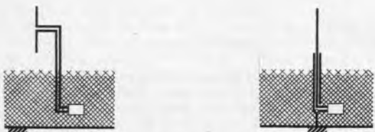
Abb. 1. Der wesentliche Vorteil der Dipol-Antenne ist vor allem der, daß die Antenne und das Gegengewicht außerhalb des Störnebels angebracht werden können.
