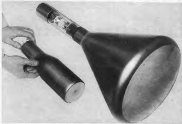
Der Vergleich der Metallfernrohr mit der Fernrohr aus Glas zeigt deutlich die weitlich kleineren Abmessungen. Vergl. auch das Bild rechts unten.
