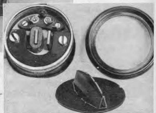
Oben: Abb. 6. Alle Einzelteile mit Ausnahme des Steges mit der Stegplatte. Rechts: Abb. 7. Das Doseninnere fertig montiert bis auf das Aufschrauben des Steges.
