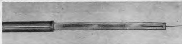
Der Draht ist durch einen Pappstreifen entsprechender Länge geföhrt.
