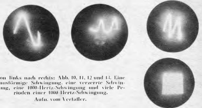
Von links nach rechts: Abb. 10, 11, 12 und 13. Eine sinusförmige Schwingung, eine verzerrte Schwingung, eine 1000-Hertz-Schwingung und viele Perioden einer 1000-Hertz-Schwingung.
