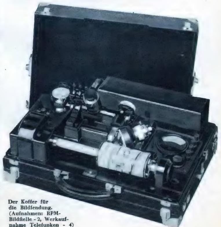
Der Koffer für die Bildfendung. (Aufnahmen: RPM-Bildstelle - 2, Werkaufnahme Telefunken - 4)
