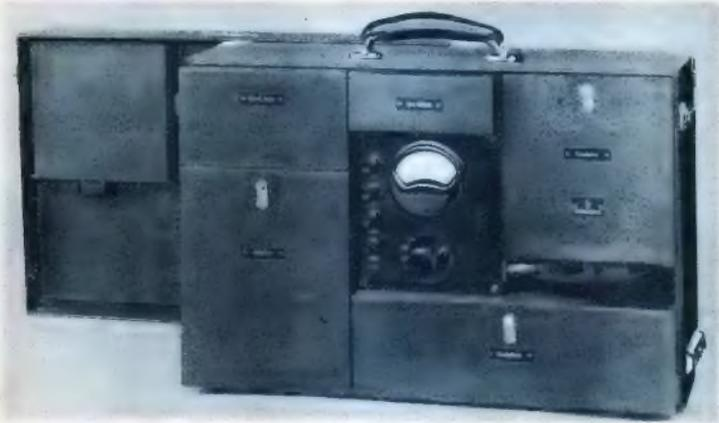
Eine tragbare Bildtelegraphie-Sendestelle besteht aus zwei Koffern, dem Koffer mit den Batterien, dem Verstärker usw., den unser Bild zeigt und dem Koffer für die Aufnahme, der im Bilde rechts unten dargestellt ist.
