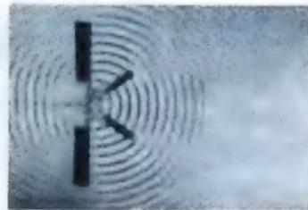
Ein durch zwei Holzstäbchen nachgebildeter Klangverteiler hebt die Richtwirkung auf. (Aufnahme erfolgte bei 7000 Hertz.)
