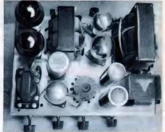
So sind die Einzelteile auf dem Chassis verteilt. Rechts in der rückwärtigen Ecke der große Netztransformator, links die beiden AD1.
