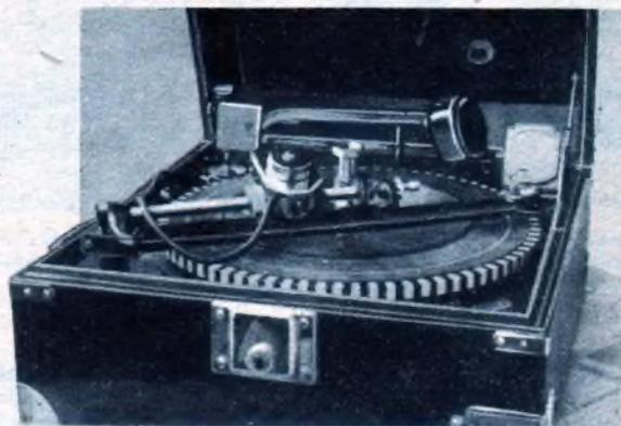
Abb. 2. Quer über den Plattenteller läuft die Halteschiene für die Schneiddose und gewährleistet, weil sie an zwei Punkten festgehalten wird, eine gute Führung der Dose. Rechts rückwärts das Instrument für die Aussteuerungskontrolle.
