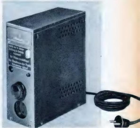
Ein Wechselrichter, mit dem es möglich ist, jeden Wechselstromempfänger an Gleichstromnetzen zu betreiben. Der Wechselrichter ist etwa so groß wie ein Lexikonband.
