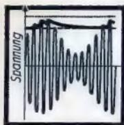
Abb. 1. Der Verlauf der Spannungen. Wir sehen dünn ausgezogen die tongepprägte Hochfrequenzspannung, punktiert eine hohe Vorspannung, gestrichelt eine geringere Vorspannung und zu dieser — dick ausgezogen — die von der Gleichrichtung herrührende Spannung.
