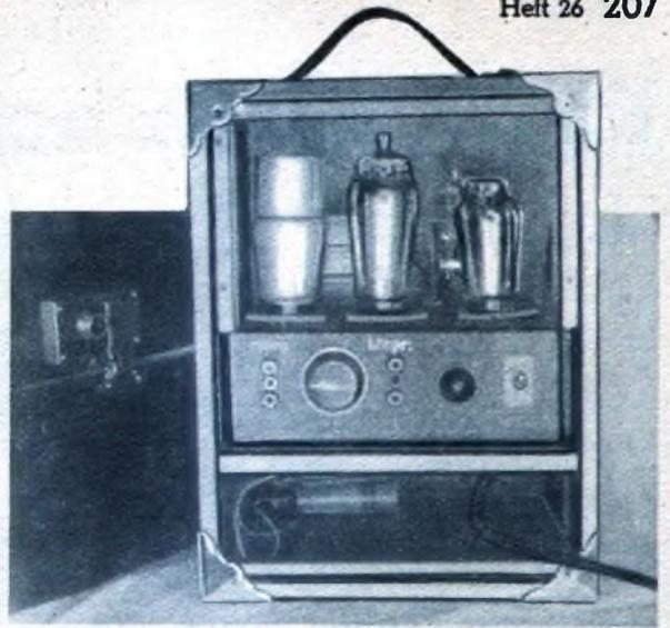
So ist der Verstärker im Koffer untergebracht. Unten der Raum für die Mikrofonbatterie und die Netzanfühlleitung. Links der verriegelbare Deckel, dessen oberer Teil mit dem Koffer durch Schrauben fest verbunden ist.
