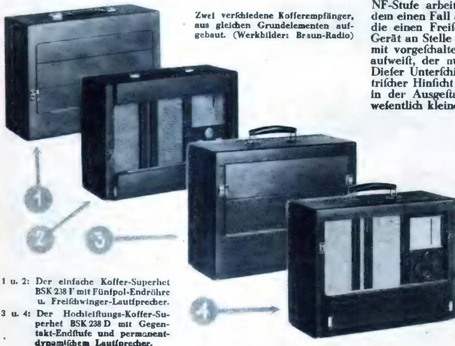
Zwei verschiedene Kofferempfänger, aus gleichen Grundelementen aufgebaut. (Werkbilder: Braun-Radio)
