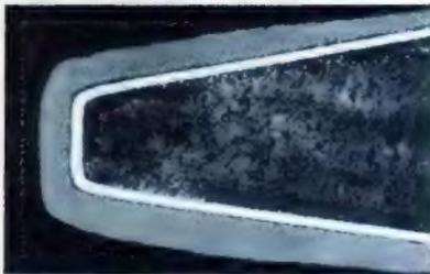
LötKolben spitze im Schnitt. Der Kupferkern ist mit einem dünnen Nickelbelag überzogen, und auf diesem sitzt die wirkliche Schicht aus gefintertem Eisen.
