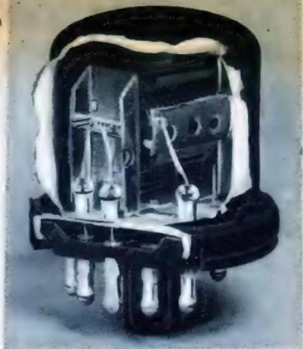
Innen-Ansicht einer Stahlröhre. Die U-förmigen Winkel, die das waagrecht angeordnete System halten, und die Fernico-Durchführungen mit dem Molybdänglasproppen sind deutlich zu erkennen.
