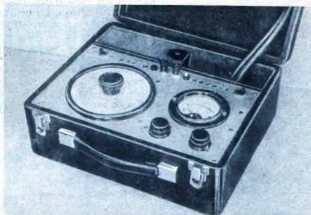
Zahlenmäßige Lautstärkevergleiche sowie die Aufnahme von Frequenzkurven werden dadurch besonders leicht gemacht. Schließlich dient das Drehpulvinstrument noch zur Kontrolle und Einregelung der Batteriespannung.
