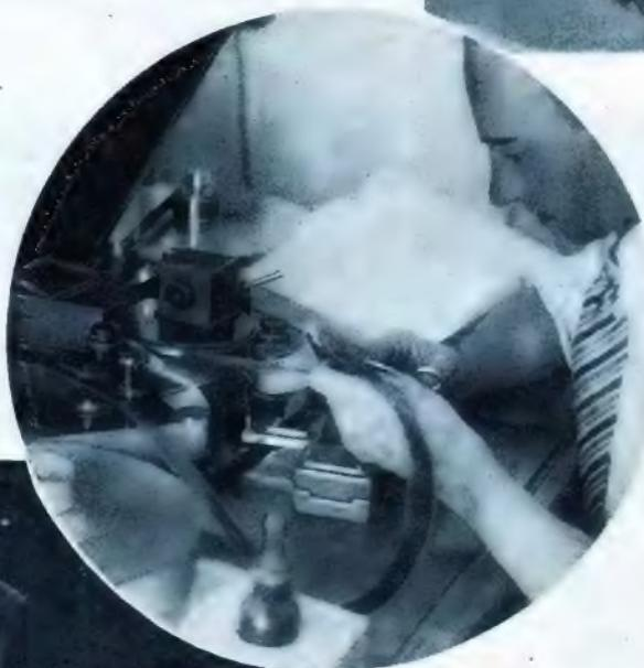
nahme die Eurocord-Apparatur herausgebracht wurde, in der die neue Eurocord-Klartonschrift zur Anwendung kommt, eine Zweizackenschrift mit Grundgeräuschlenkung, die von einem Lichthahn aufgezeichnet wird (im Lichthahn z. B. macht man von interessanten grundlegenden Forschungsergebnissen Gebrauch, die ursprünglich für den Siemenschen Schleifen-Oszillographen gewonnen wurden und auf denen Gerlach dann in seiner Lichthahnenentwicklung weiterbaute).
