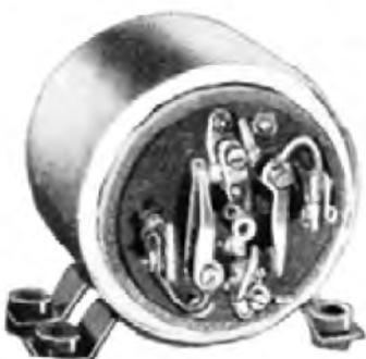
Das Unterbrechersystem des Telwa-Wechselrichters.
