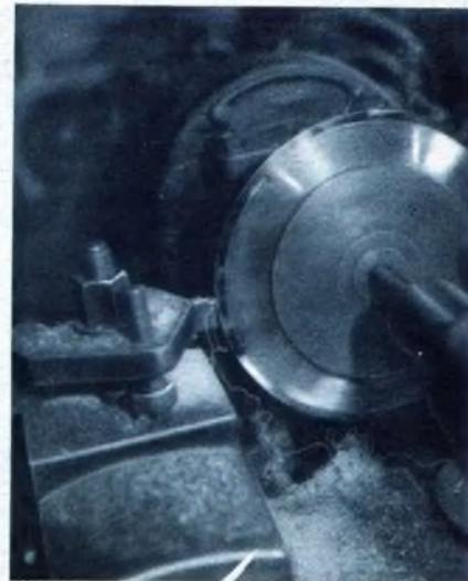
Die Preßmatrize wird auf der Drehbank sauber abgedreht, ehe sie in die Schallplatten-Preßerei kommt.
