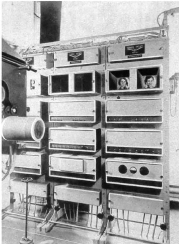
Mit Hilfe dieser Geräte wird die Güte des Fernsehbildes bei den Fernsehensprechverbindungen der Deutschen Reichspost überwacht
