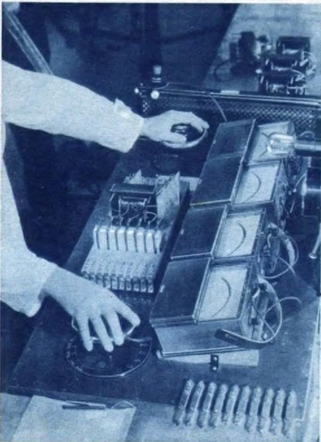
Die Prüfung von Netztransformatoren erfolgt einfach durch Betätigen zweier Schalter und Beobachten von vier Instrumenten und einer Glühlampe. (Werkbild: Blaupunkt)
